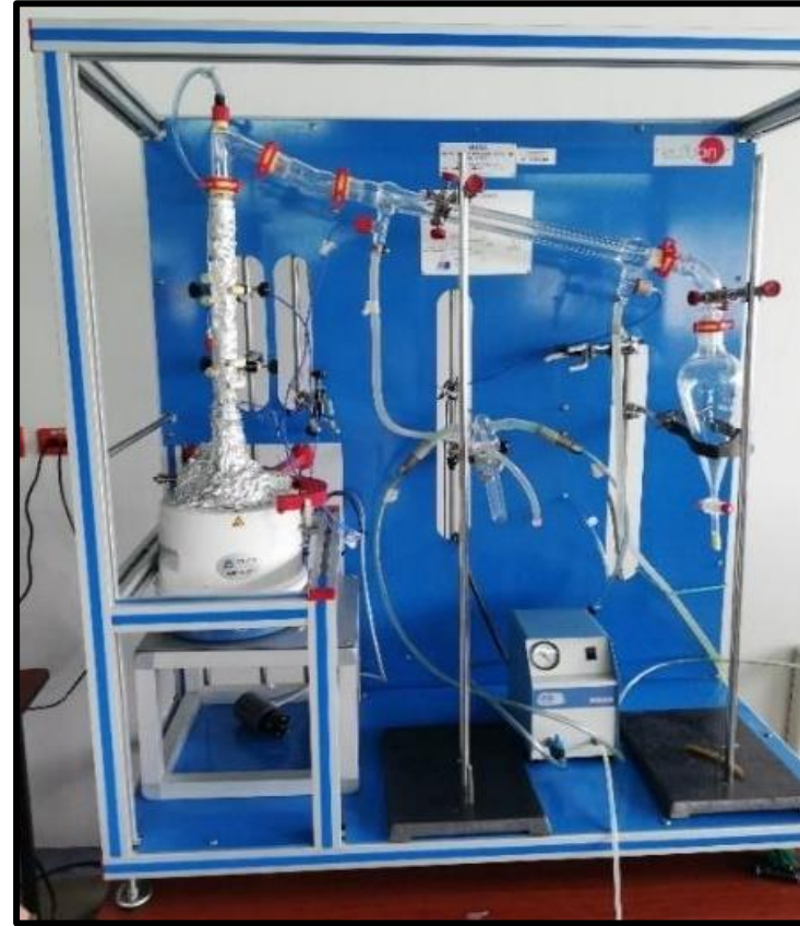
ARMADO DE LA COLUMNA DE CRAQUEO
