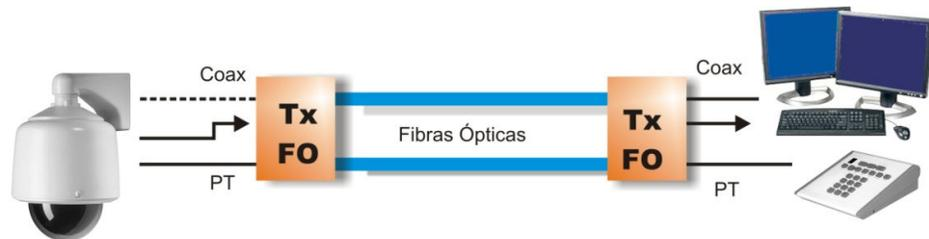
**Figura 2.3 Transmisión de cámara domo por fibra óptica**
