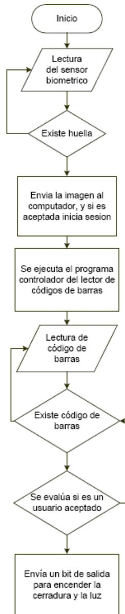
**Figura 2.11 Esquema general del control de acceso.**
