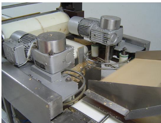
Figura. 3.23. Pistones utilizados para detener las obleas hasta que se forme la galleta
