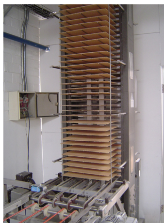
Figura. 2.9. Arco de enfriamiento
