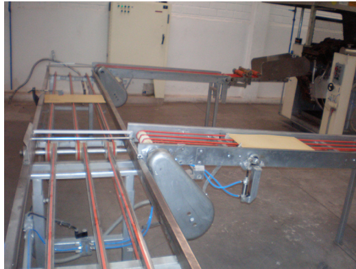
Figura. 2.8. Detención de oblea en la banda de salida del horno2
