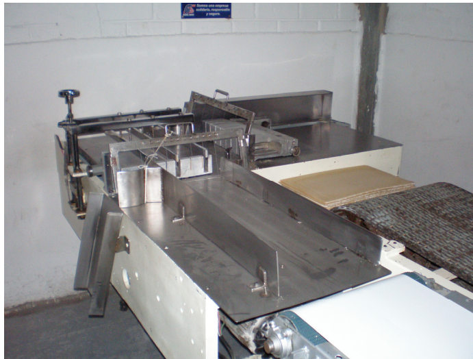
Figura. 3.27. Cortadora de galletas
