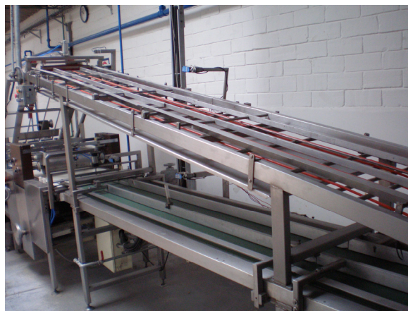
Figura. 2.11. Bandejas de la untadora de crema
