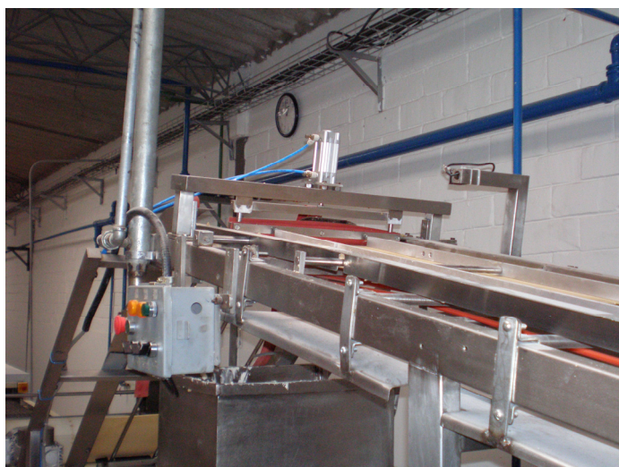
Figura. 3.13. Compuerta superior de la untadora de crema
