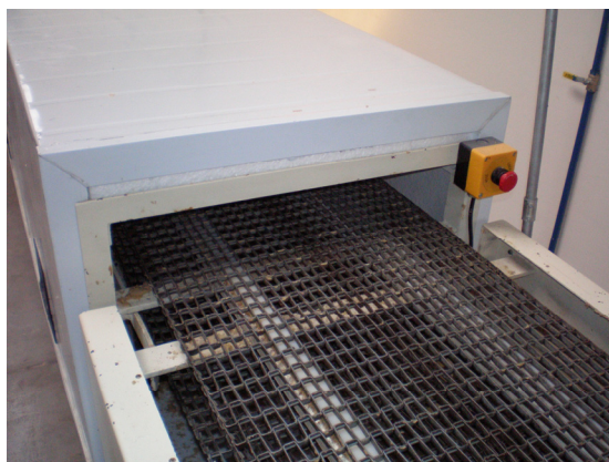
Figura 5.6. Ubicación del paro de emergencia del túnel de enfriamiento
