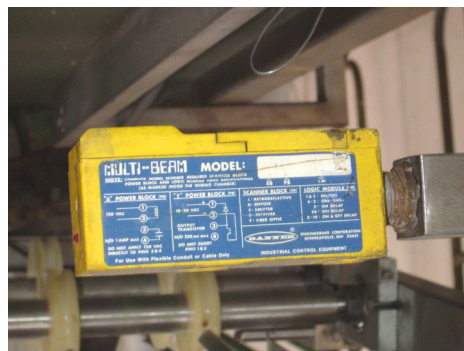
Figura. 3.29. Sensores MULTI BEAM
