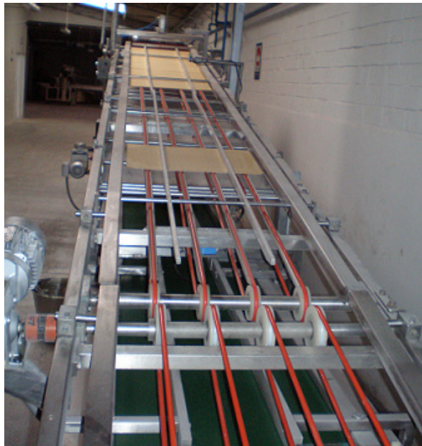
Figura. 3.12. Distribución de obleas a la banda superior
