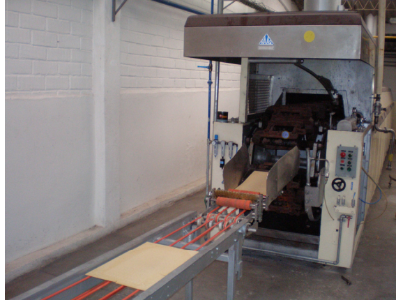
Figura. 3.4. Banda transportadora a la salida del horno1
