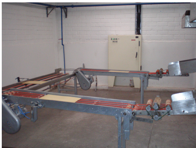
Figura. 3.8. Descarga de obleas a la banda principal
