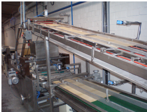
Figura. 3.24. Bandejas cargadas de obleas
