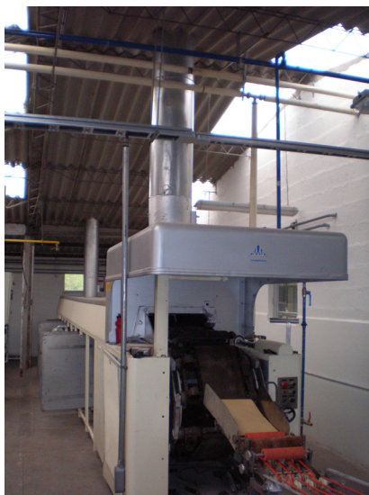
Figura. 2.7. Chimeneas de los hornos
