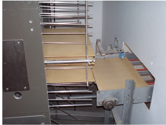
Figura. 3.10. Sensor que acciona el movimiento del arco en modo automático
