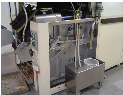
Figura. 2.3. Recipiente de almacenamiento para la pasta
