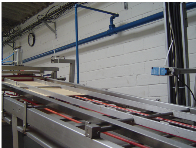
Figura. 3.16. Sensores de la bandeja superior
