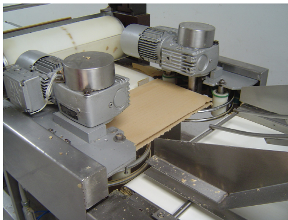
Figura. 3.22. Espirales encargados de formar la galleta
