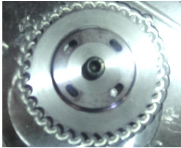
Figura 5.71: (Piñón regulable terminado)
