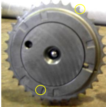
Figura 5.75: (Marcas de sincronización del piñón del árbol de levas de admisión estándar)
