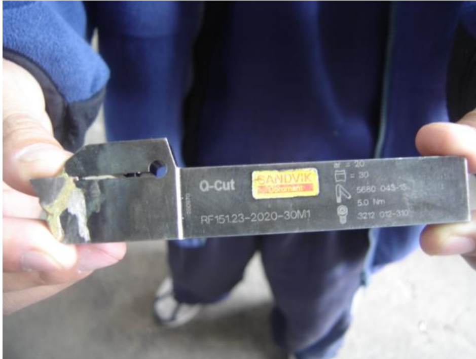
Figura 5.18: (Embridado sujeción por tornillo RF151.23-2020-30M1 utilizado en el torneado árbol de levas)
