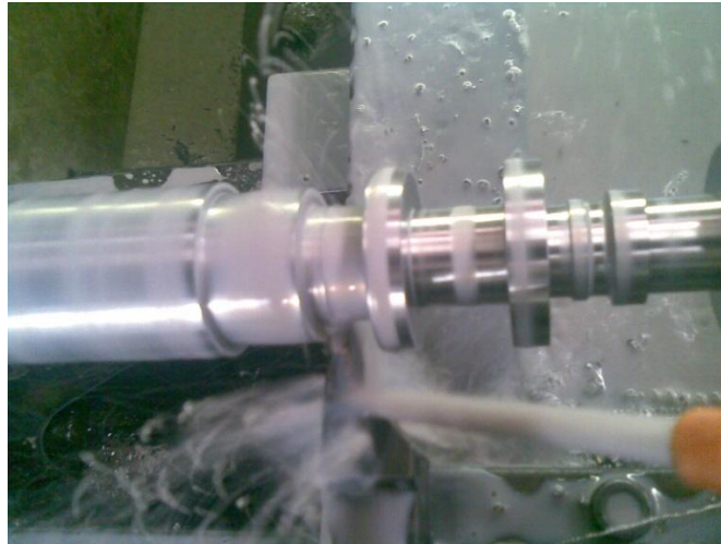
Figura 5.51: (Ranurado de uno de los muñones árbol de levas)
