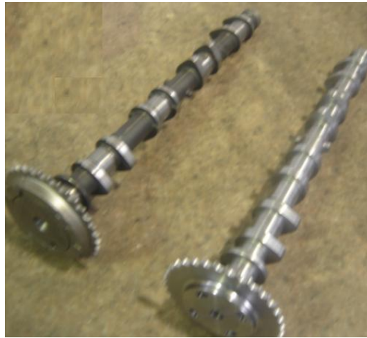
Figura 5.73: (Árbol de levas original y Árbol de levas con perfiles modificados terminado)
