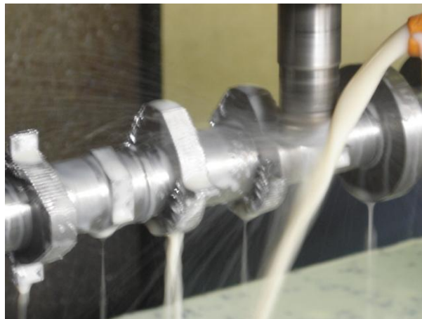
Figura 5.59: (Desbaste grueso del perfil del segundo par de levas con el eje z constante)
