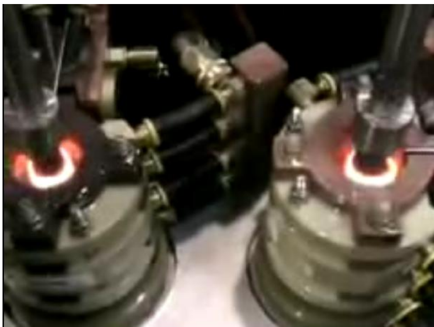
Figura 6.2 : (Tratamiento Térmico por Inducción en árboles de levas InductoTherm Group)
