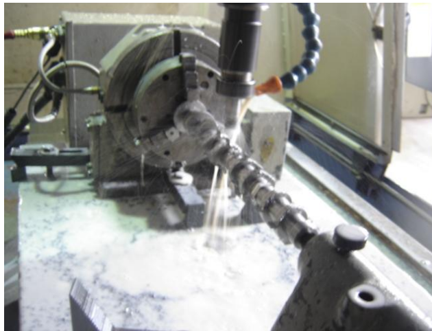
Figura 5.60: (Desbaste grueso del perfil del tercer par de levas con el eje z constante)
