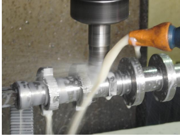
Figura 5.58: (Desbaste grueso del perfil del primer par de levas con el eje z constante)
