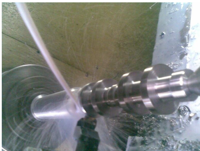
Figura 5.50: (Torneado del árbol de levas)
