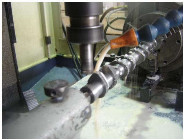
Figura 5.63: (Acabado en el primer par de levas mediante el movimiento de la herramienta con el eje z variable)
