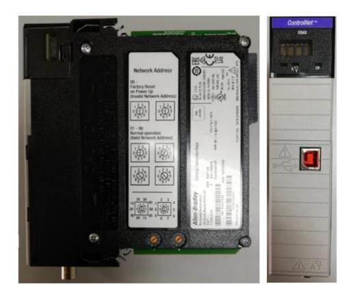
El módulo 1756 CN2 usa medios físicos estándar con una velocidad en baudios de 5 Mbps, permite 128 conexiones Logix y un máximo de 99 nodos. (Rockwell Automation, Inc).
