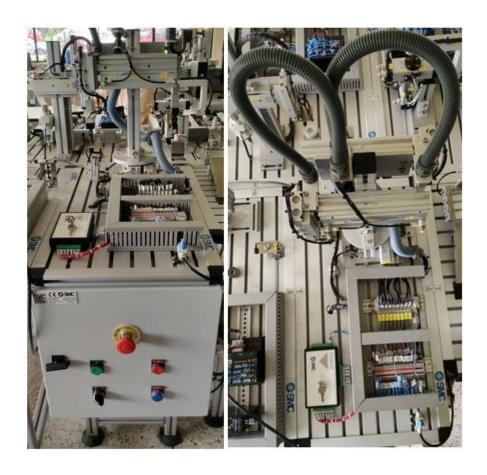
La estación central realiza el traslado de las piezas desde las estaciones MAP-202, MAP-203 y MAP-204 hacia la estación MAP-201. La estación central MAP-205A mediante dos pinzas neumáticas de dos dedos traslada cada uno de los componentes como el rodamiento que se
