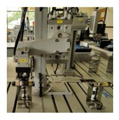
• Con la pieza en la posición inicial un manipulador basado en un actuador de giro tipo piñón-cremallera, el cual gira 180° para llevar al rodamiento de la posición inicial hacia el punto de alimentación final para que el alimentador central disponga del rodamiento para el ensamblaje.
