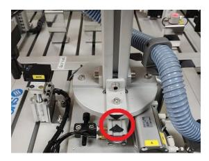
Al establecer el correcto posicionamiento inicial del brazo de traslado de piezas también evita que el conducto plástico que sostiene las mangueras y cables de los actuadores se tensione de manera que dañe su estructura física.
