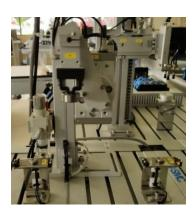
• El agarre lo realiza con una pinza de dos dedos de apertura paralela, sujeta al rodamiento de la parte interna.
