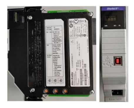
El módulo 1756 EN2T usa medios físicos de cobre con una velocidad en baudios de 10/100Mbps, permite 128 conexiones TCP/IP y 256 conexiones Logix. (Rockwell Automation, Inc).
