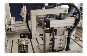
• Con la pieza en la posición inicial un manipulador basado en un actuador tipo rotolíneal, lleva al rodamiento de la posición inicial hacia el punto de alimentación final para que el alimentador central disponga del eje para el ensamblaje.
