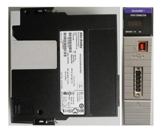
El módulo 1756 DNB permite el intercambio de datos a una velocidad de 125 Kbps (500m máx), 250 Kbps (250m máx), 500 Kbps (100m máx) y un máximo de 64 nodos. (Rockwell Automation, Inc).
