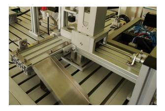
• Para verificar la correcta posición la estación dispone de un cilindro que avanza introduciendo una pieza cilíndrica en el alojamiento de la base.
