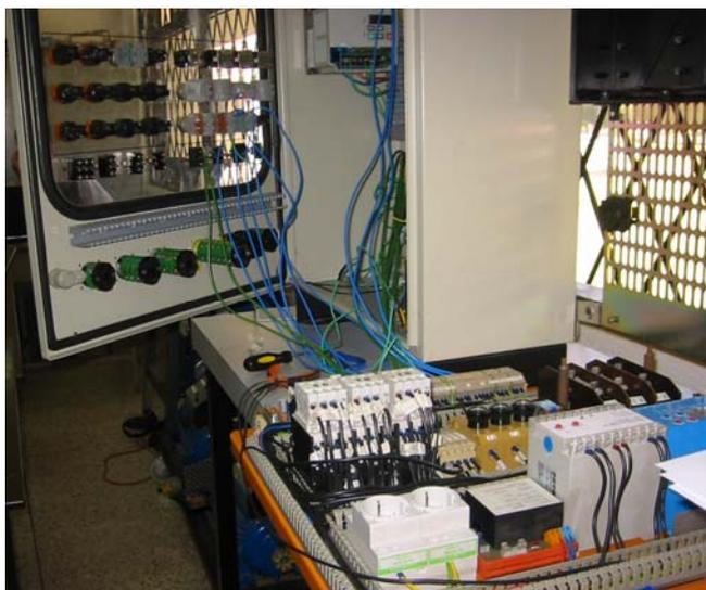
**Figura. 4. 15. Circuito de prueba para el Sistema Eléctrico y electrónico de la Balanceadora TIRA K300**
