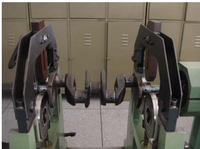
**Figura. 5. 1. Ubicación del cigüeñal en los soportes de la Balanceadora K300**
