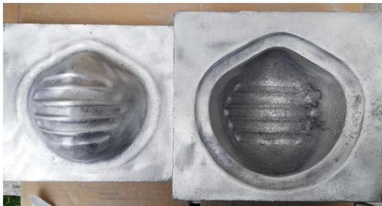
El proceso de fundición se lo realizo con una aleación de aluminio blanco de alta pureza de 99.7 a 99.5%.
