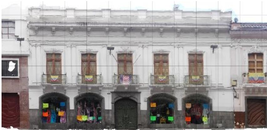
**Ortofoto.** Se crea a partir de la malla tridimensional y el resultado es una imagen con proyección ortogonal. Debido a las limitaciones existentes para realizar la toma de fotografías, las zonas que no fueron cubiertas generan huecos en la imagen.
