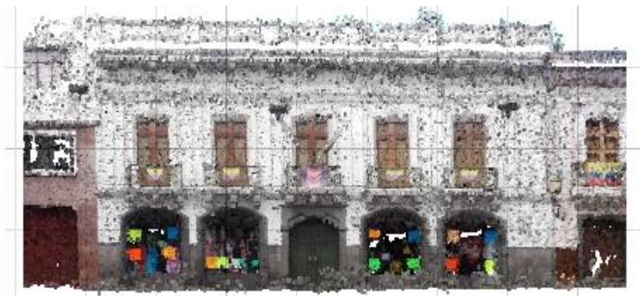
**Malla tridimensional.** La malla 3D a partir de la nube de puntos se genera por la conexión de estos mediante triángulos o cuadriláteros. Se realiza en una calidad alta y la fuente de datos los mapas de profundidad. A la representación 3D se le puede o no generar textura para dar color lo más parecido a la realidad y mejorar la estética del modelo.
