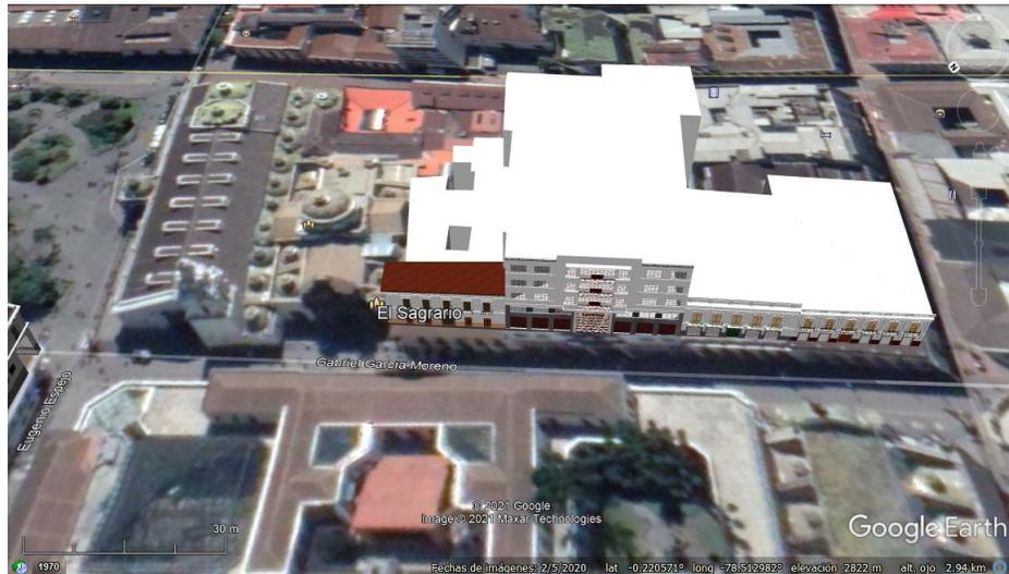
***Exactitud posicional relativa y fidelidad geométrica.*** Estos dos elementos se evaluaron en conjunto con el método NIST del apartado 4.3.3.1. El conjunto de 83 muestras, 42 para exactitud posicional y 41 para fidelidad geométrica, se aceptó con 0 defectos encontrados al 95% de confianza. Esto indica que, todos los datos tuvieron una discrepancia entre la medida real y la medida virtual menor a 15 cm.
