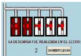
Depósitos de Lodos, sus electroválvulas y la visualización para el control de los lechos sucios.
