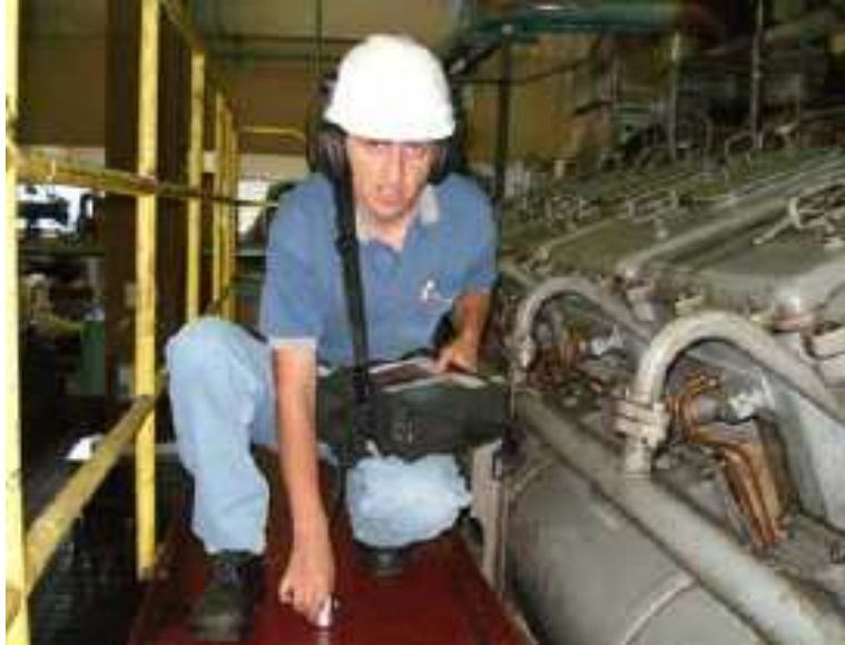
Figura 4.4. Monitoreo de vibraciones
