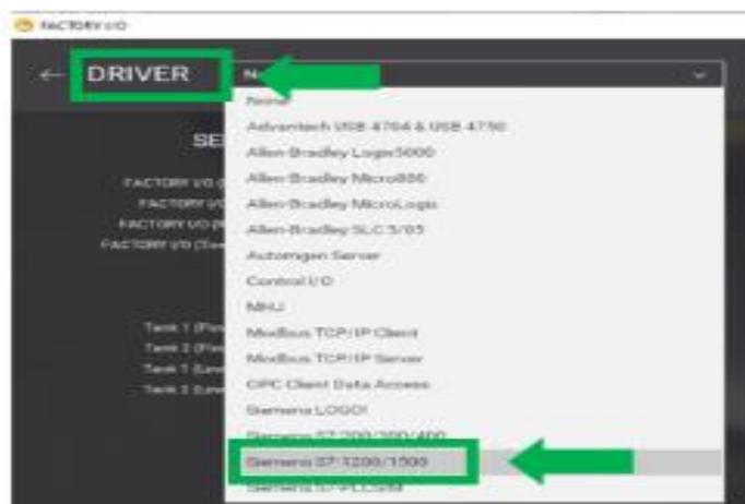
Continuando con el procedimiento se configura como punto 1 de la Figura 141 el dispositivo que posee, en este caso el S7 1200, en la opción que se muestra en el punto 2 de la Figura 141 y en la parte se dispone las entradas y salidas, en donde se agrega 2 entradas tipo BOOL, 2 salidas tipo BOOL, y para señales analógicas se escoge 4 entradas tipo Word, y 5 salidas tipo Word que serán parte del control del proceso de nivel que se muestra en el punto 3 de la Figura 141.
