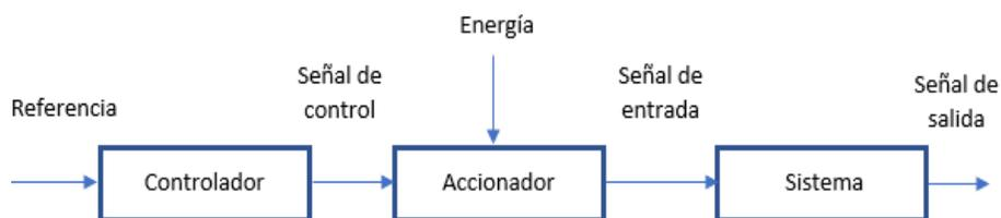
*Nota:* En la imagen se muestra un diagrama de un sistema de estabilización en lazo abierto. Tomado de (Ogata, 2010)
