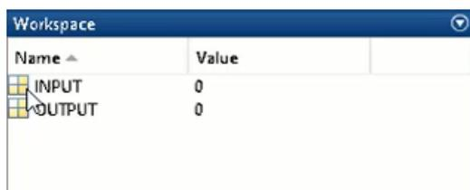
A continuación, Se inicia con el ingreso de los valores obtenidos en el archivo. .xls, iniciando con la primera columna de datos como se indica en la Figura 105, los cuales vienen a ser parte de la entrada y se ingresa en la matriz INPUT del software Matlab. De la misma manera para la parte de la salida y se ingresa en la matriz OUTPUT como se observa en la Figura 106.
