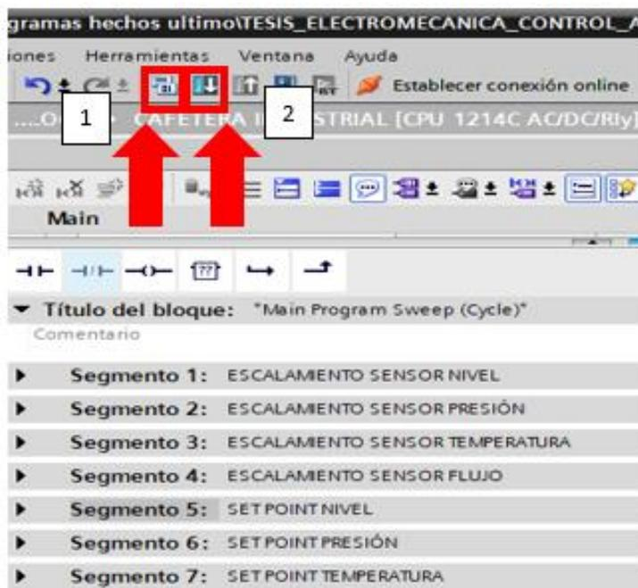
*Nota:* La imagen muestra la pantalla principal de TIA Portal, en donde se realiza la compilación como paso 1, y la carga del programa al dispositivo como paso 2.
