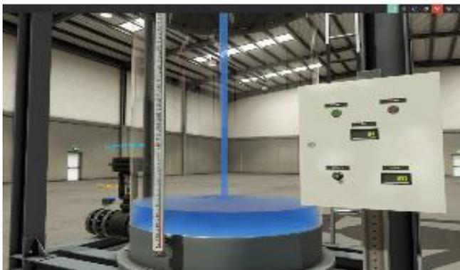
En la visualización del proceso virtual de nivel, se evidencia que los instrumentos trabajan de manera correcta, al haber realizado sintonización con el software de TIA Portal, en el cual se utilizó la herramienta de sintonización fina por medio de la cual se obtiene los parámetros de ajuste adecuados, para que el sistema se estabilice de manera adecuada.
