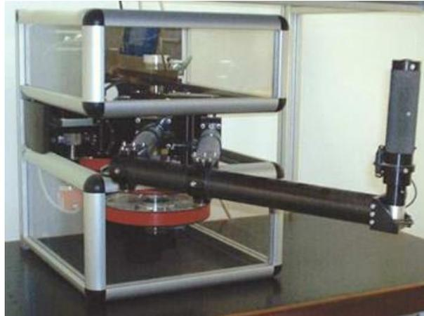
*Nota:* El robot de rehabilitación vBot automatiza la fisioterapia de las extremidades superiores. Tomado de (Newport, 2006)
