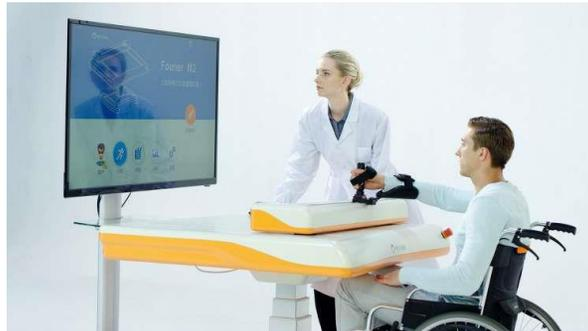
*Nota:* Representa el sistema de rehabilitación Fourier M2 el cual utiliza juegos para el proceso de recuperación y para el aprendizaje motora de la extremidad afectada.
