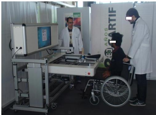
*Nota:* Los prototipos de rehabilitación de las extremidades superiores tienen un área de trabajo en el plano XY y por lo general hay un especialista controlando el dispositivo de fisioterapia. Tomado de (Fraile, Turiel, Viñas, Alonso, & Martin, 2018)
