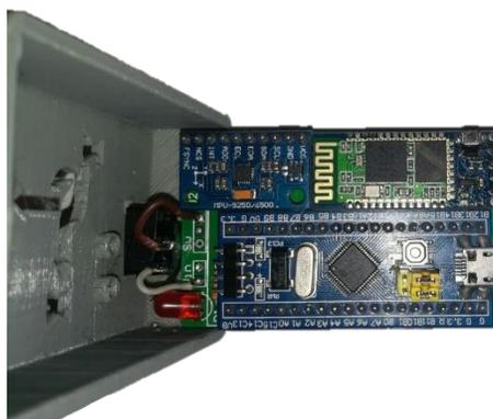
*Nota:* Representa el acople del circuito IMU con la caja de PLA.
