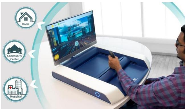
*Nota:* El dispositivo Robot H-Man permite dar asistencia de forma automática a las extremidades superiores de modo que el especialista no interviene. Tomado de (Polo, 2020)
