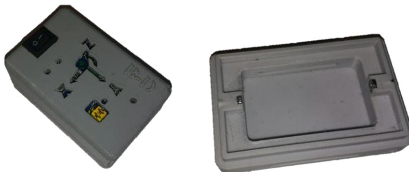
*Nota:* Representa la caja final de PLA funcional con la unidad de medición IMU
