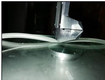
*Nota:* Manguera presionada sobre una balanza digital para analizar el valor de la presión. Realizado por los autores (Lascano, Navas, 2020)
