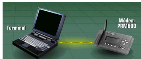
Figura. 6.17. Detalle de terminal y radiomódem
