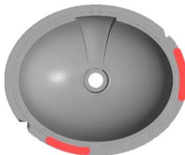
**Figura 28***Zonas de desbaste del Lavabo Rondo*
