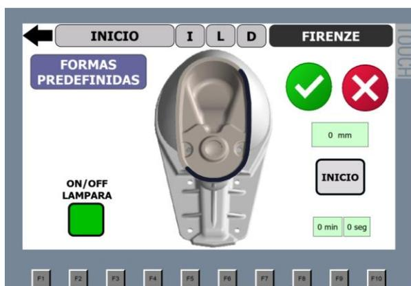
Las zonas a desbastar seleccionadas pueden ser consecutivas de dos, tres o cuatro secciones dependiendo en donde se encuentre el error de pandeo, el operador debe seleccionar estas zonas mediante un pulso.
