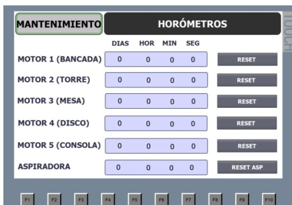
La obtención del tiempo de funcionamiento permite tener datos más exactos del consumo energético de los motores que son parte del proceso para controlar la bancada, torre, mesa, consola, disco de desbaste y el aspirador de polvo. Cuenta con botones de reset que permiten regresar los contadores a cero según el criterio de los técnicos del área de mantenimiento y tiene un botón de acceso directo a la pantalla de mantenimiento.
