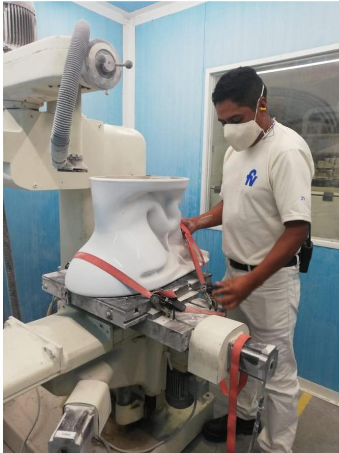
El desbaste que genera la máquina rectificadora se observa en la Figura 83 en donde las zonas 3 y 4 de la base del Inodoro Firenze tienen la corrección necesaria para ser clasificada como de primera calidad.
