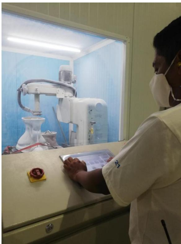
Al culminar el proceso el operador retira la pieza cerámica del interior de la cabina como se observa en la Figura 82 y obtiene una pieza con la tolerancia permitida para clasificarla como de primera calidad.
