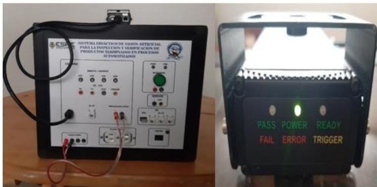
Para verificar el correcto funcionamiento de las entradas y salidas digitales de la cámara se realiza la interacción entre estas y el actuador del módulo físico obteniendo como resultado la activación de una luz piloto como se presenta en la Figura 52.
