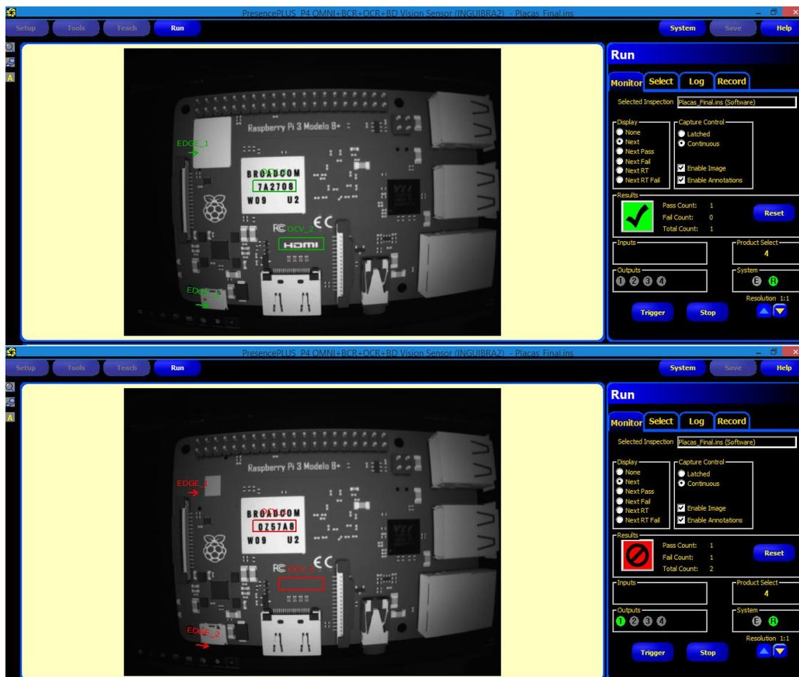
Nota. En la parte superior se observa la aceptación del producto sin errores de producción y en la parte inferior se observa el rechazo del producto defectuoso.
