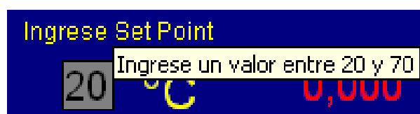
Figura. 6.4. Ingreso de set point
