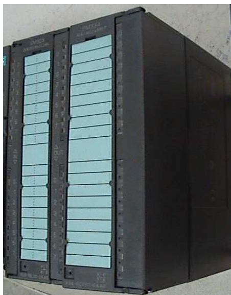
Figura. 3.4. Módulos de I/O
