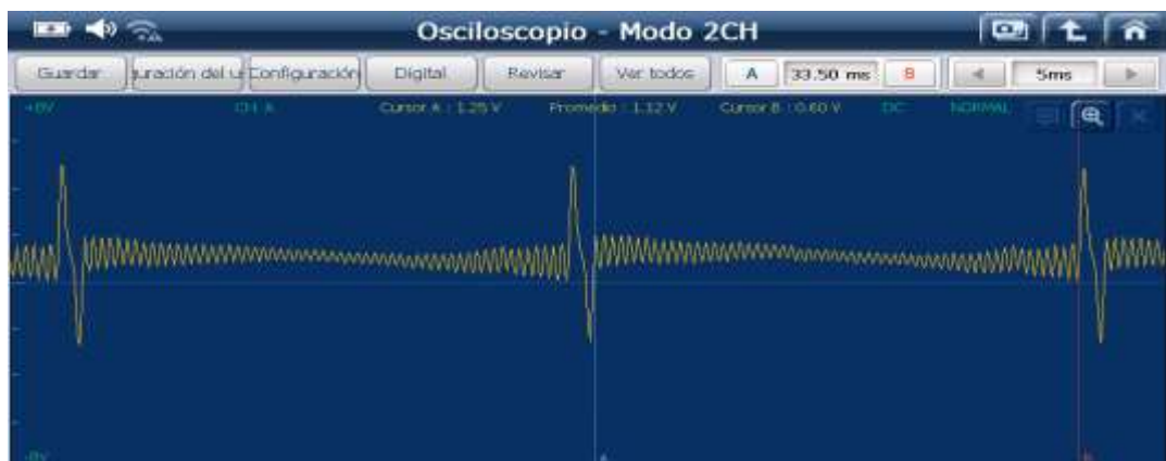
Gráfico 61. Curva del sensor (CKP) tomada del pin B
