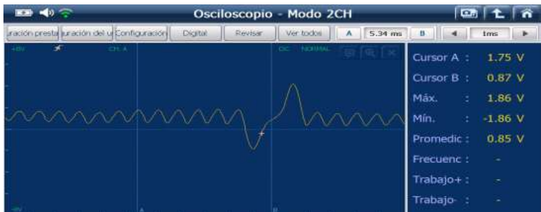
Gráfico 59. Curva del sensor (CKP) control de inyección
