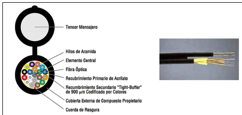
Figura 3.34 Cable aéreo figura 8
