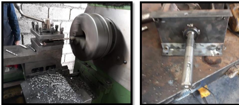
**Figura 44 Mecanizado de acople de ejes**
