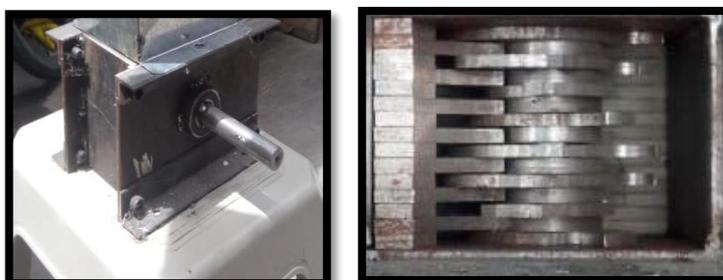
**Figura 42 Construcción de la Cámara de trituración**
