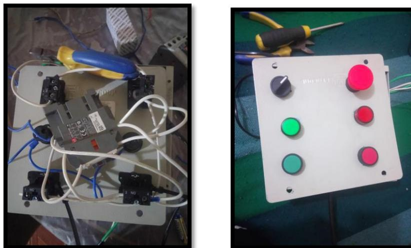
**Figura 48 Tablero de control con sus componentes eléctricos**
