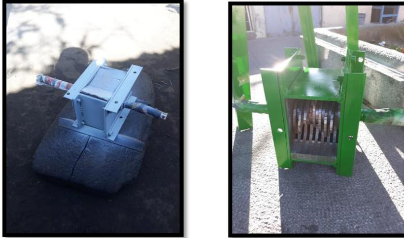
**Figura 45 Pintado de la cámara de trituración**
