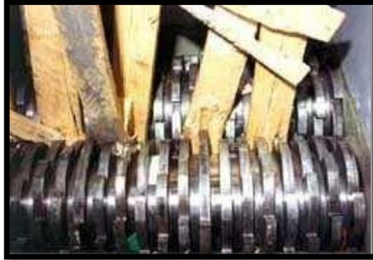
**Figura 11 Trituradora de cuchillas**
