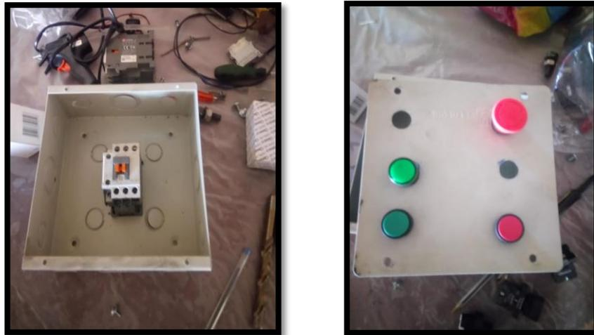
**Figura 47 Montaje tablero eléctrico**
