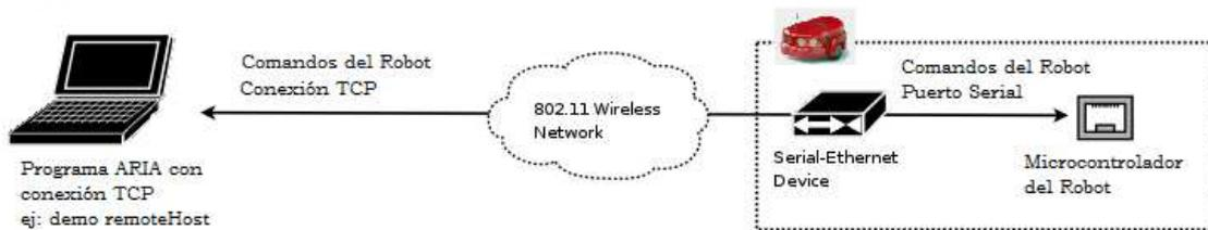
Figura. 5.3. Modo de Conexión 3-4
