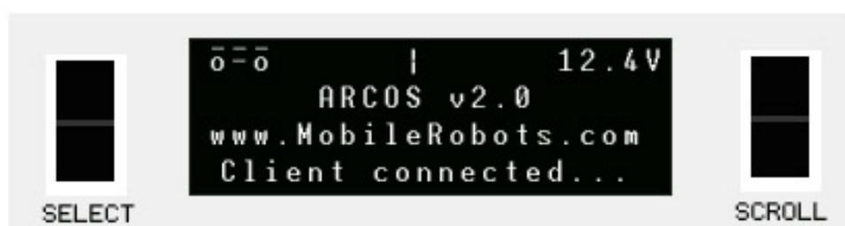
Figura. 3.7. Pantalla LCD equipada con el Robot P3-AT
