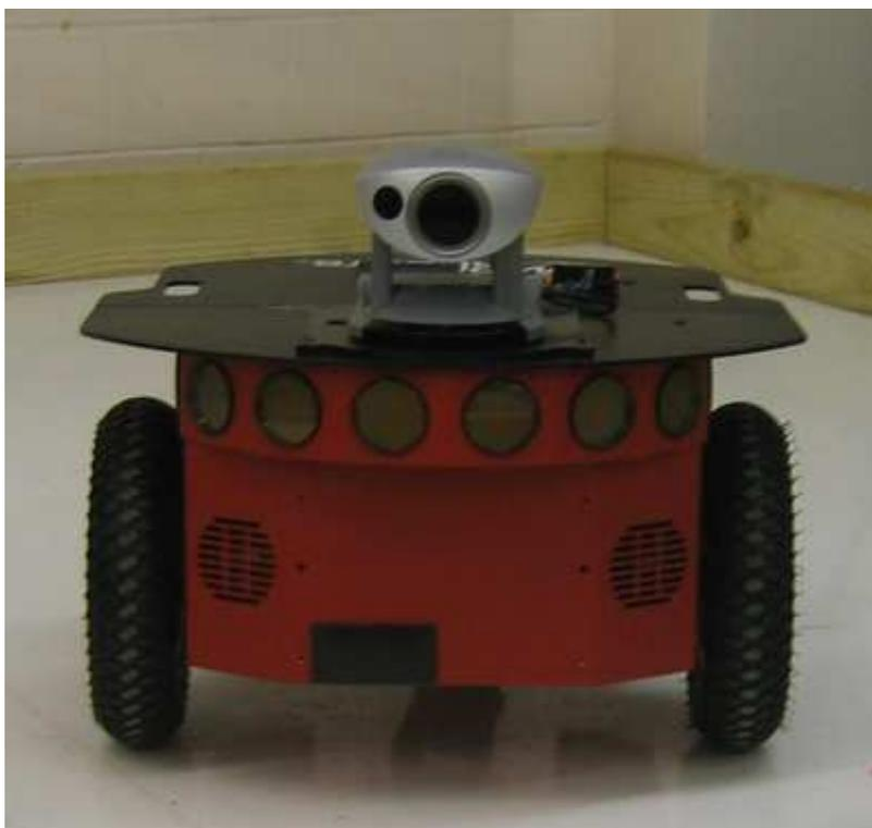
Figura. 4.4. Discos sensores tipo Sonar
