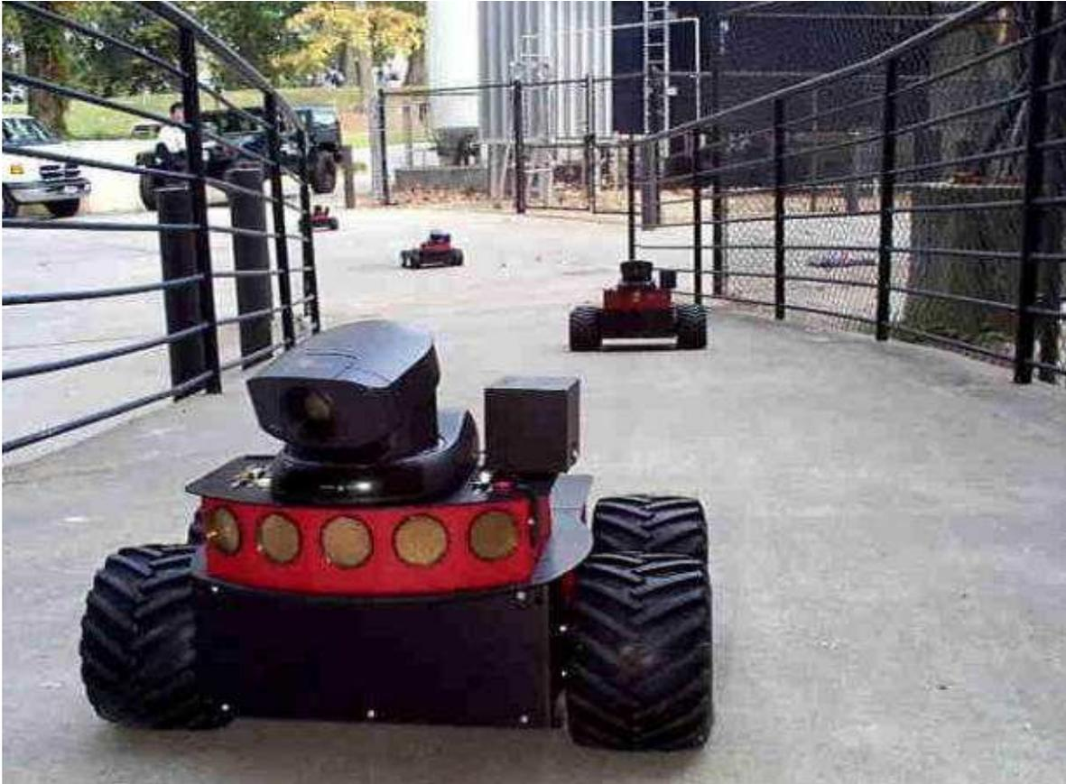
Figura. 6.3. Aplicación de evasión de obstáculos siguiendo una trayectoria
