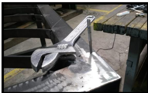
Figura 35. Proceso de roscado.
