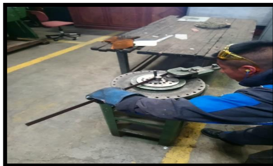
Figura 28. Doblado de la platina.
