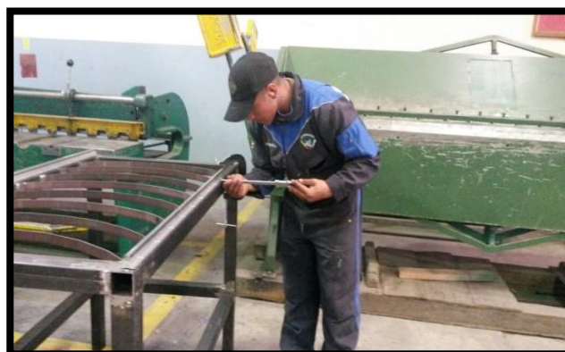
Figura 33. Calibración de los rieles SBR 12mm.
