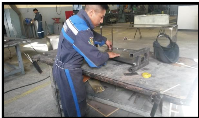
Figura 31. Suelda del cabezal porta ejes (X, Z).
