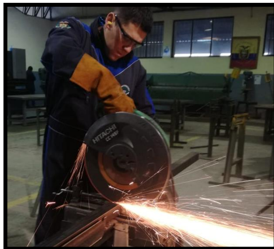
Figura 22. Corte de tubos cuadrados.
