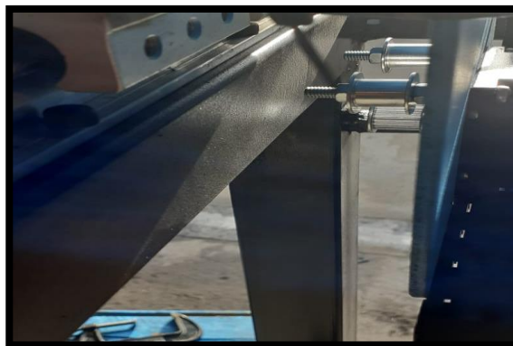
Figura 59. Poleas lisas y dentadas.
