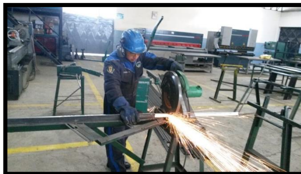
Figura 32. Corte de rieles SBR 12mm.
