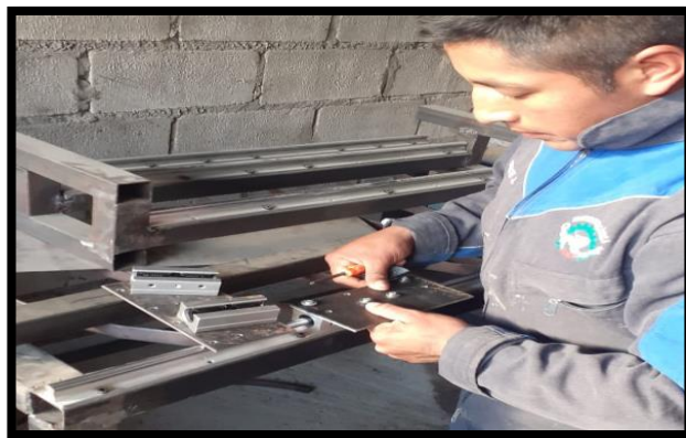
Figura 7. Rodamiento lineal SBR 12uu y Riel SBR12mm.
