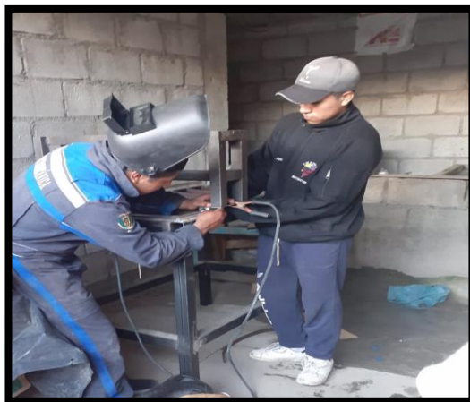
Figura 40. Proceso de soldadura cabezal.
