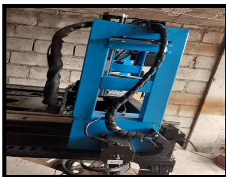
Figura 64. Cableado de electrónica exterior.
