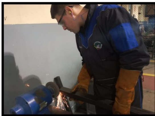
Figura 23. Extracción de las rebabas.
