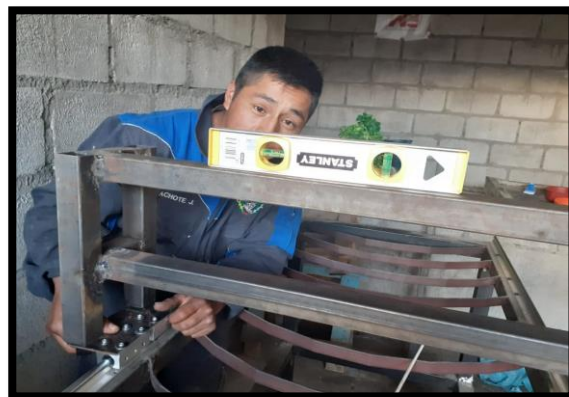
Figura 39. Proceso de calibración del cabezal.
