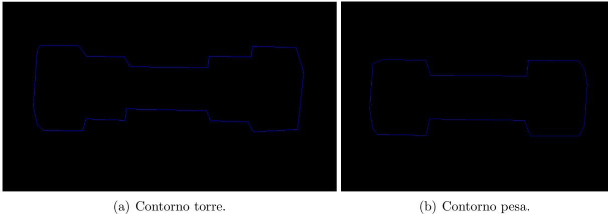
Figura 3.9: Aplicación de encadenamiento y aproximación poligonal en los objetos cilíndricos.
