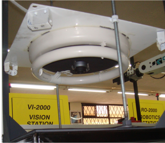
Figura 2.22: Montaje iluminación y cámara web.
