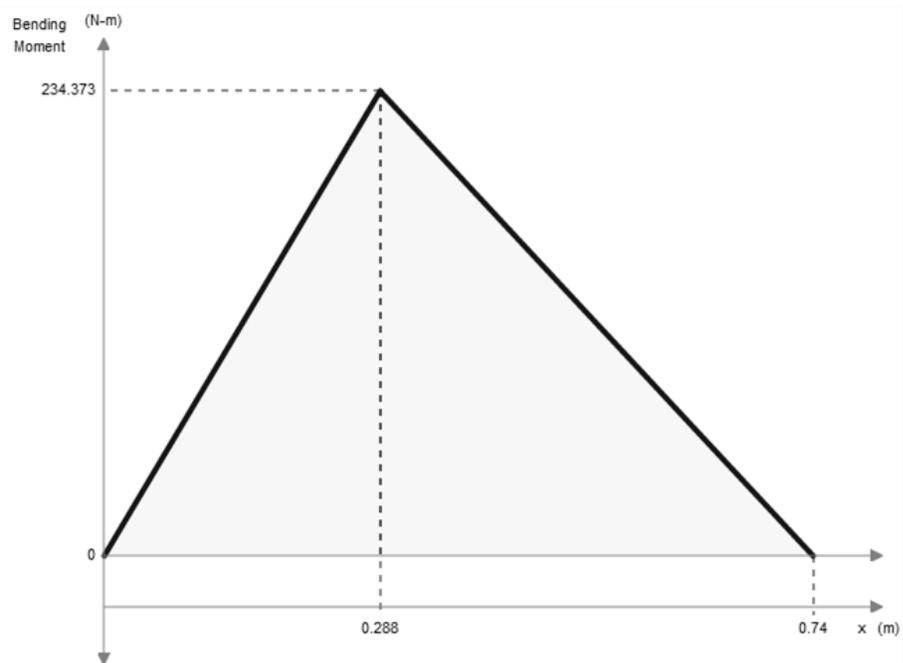
Lo que determina un momento máximo de  $M_{max} = 234.373 [Nm]$  el cual se usará para determinar el esfuerzo máximo al que será sometido la V3. Esto proporciona un dato para un primer análisis y acercarse a un perfil adecuado.
