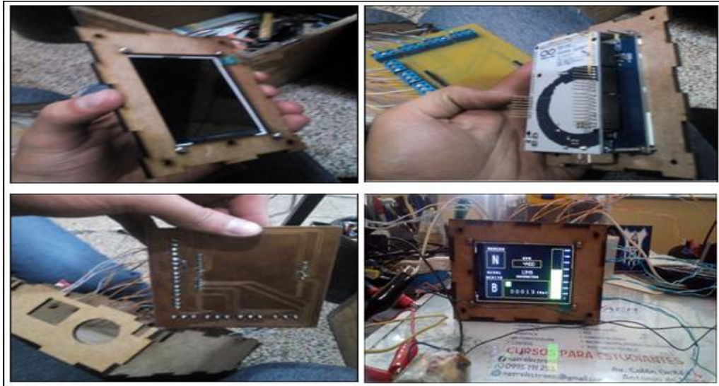
Figura 52 Armado de caja base del Indicador
