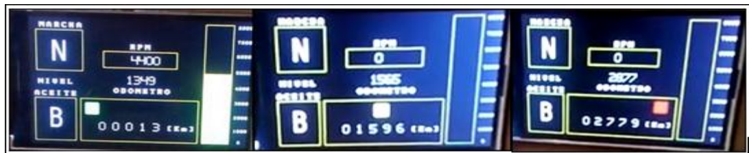
Figura 47 Indicador tipo semáforo Estado de Aceite
