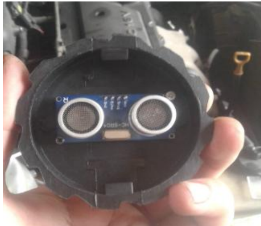
Figura 57 Sensor Ultrasónico adaptado En tapa de depósito
