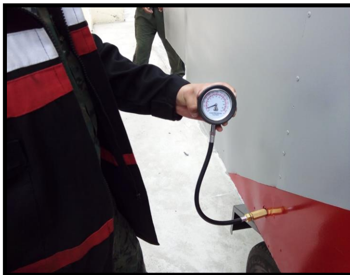
Figura 42 adaptación de un manómetro en toma externa.
