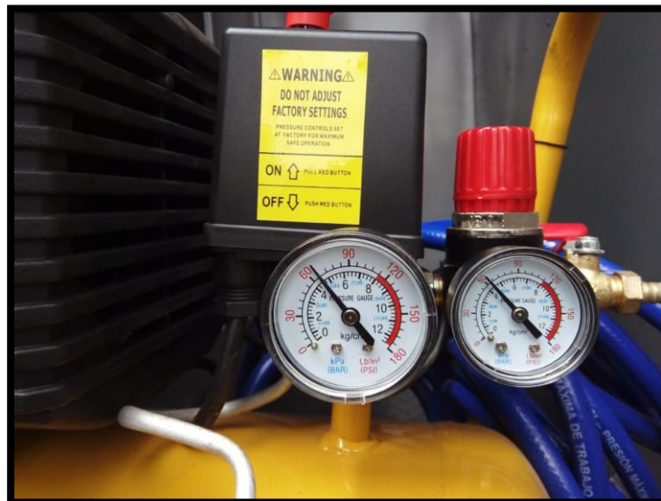
Figura 37 Manómetros marcando 65 kpa en 01:30 min de trabajo.
