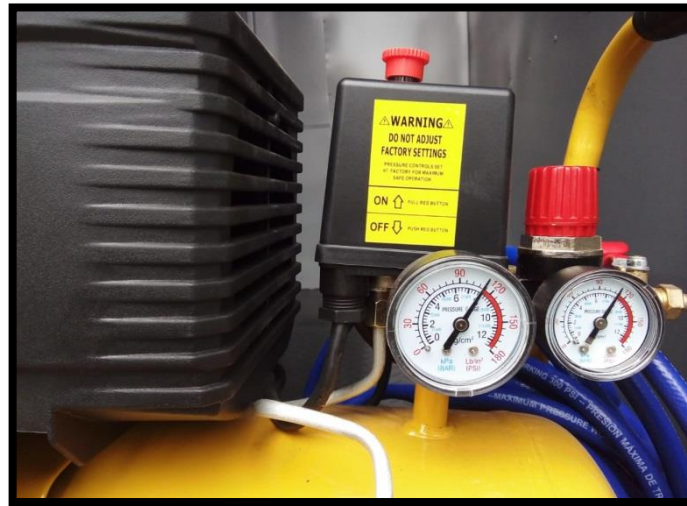
Figura 39 Los manómetros llegan a 110 kpa en 3 min.
