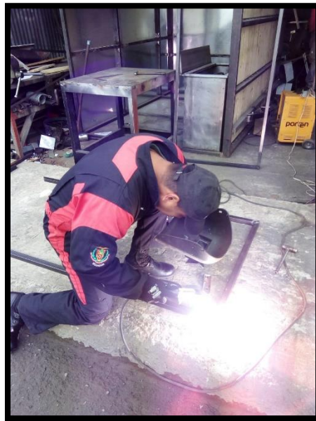
Figura 27 Proceso de suelda de los tubos
