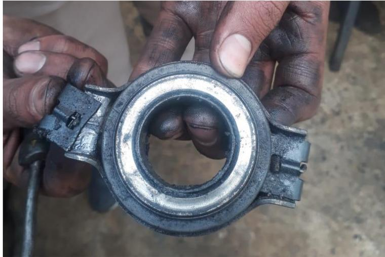
Al momento en que se vuelve a montar todo este conjunto en la caja de cambios, se debe ser cuidadoso de que todos los seguros y guías estén colocados de manera correcta, de lo contrario, se tendrá problemas en el funcionamiento y se puede deteriorar otros elementos.
