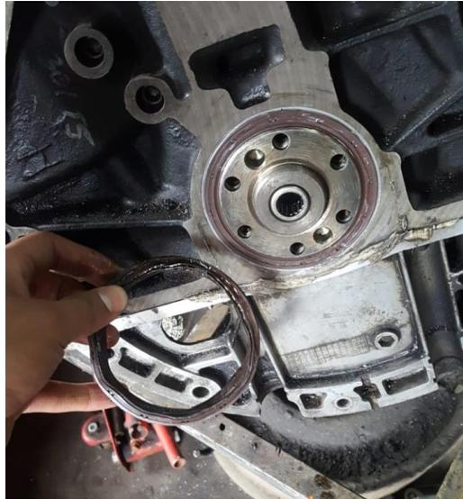
5. Dejamos secar el silicón y montamos el volante de inercia. Para montar el volante de inercia del motor, es importante que al apretar los pernos lo hagamos con el torque recomendado por el fabricante, así aplicaremos la misma fuerza en todos los puntos de ajuste y se evitará problemas de balanceo en el volante de inercia.
