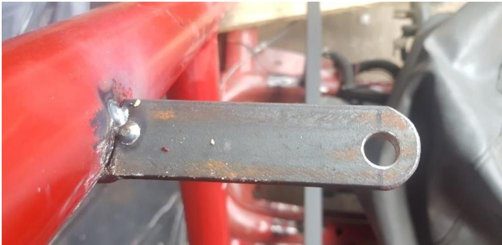
4. Cuando las bases del radiador ya han sido fabricadas, las soldamos en la estructura del buggy, la suelda debe ser precisa y cumplir con los requisitos para poder soportar las vibraciones emitidas por el motor y el peso del radiador.
