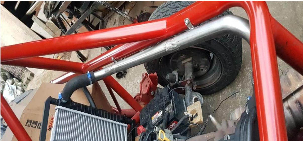
9. Se instalaron las cañerías, asegurándose que estén sujetas y que no se van a mover de su lugar por efectos de la vibración del motor, o la presión presente en el sistema de refrigeración.
