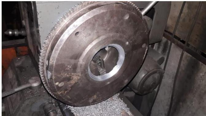
2. Se comprobó que las piezas mecánicas son exactas y están listas para proceder al proceso de soldadura. Utilizando un electrodo especial para fundición de acero (electrodo 316L-16), material que constituye al volante de inercia, soldamos el volante de inercia y el eje central mecanizado.
