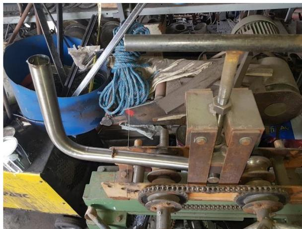
Fue necesario que, mientras se van realizando los dobleces y formas del tubo de acero inoxidable, se lo vaya comprobando poco a poco, con el fin de corregir ciertos errores y no se eche a perder el material.
