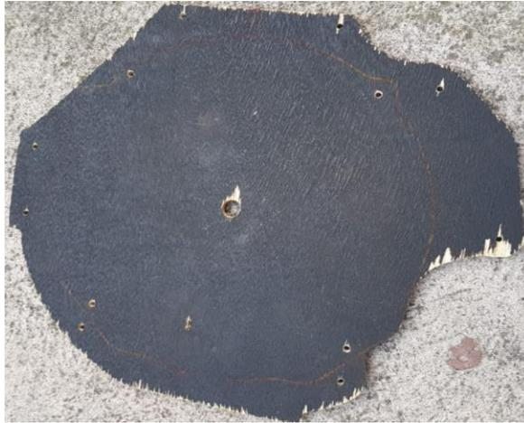
12. Medimos desde el punto centro un radio de 110mm, trazamos una circunferencia, misma que será el espacio por donde pasa el volante de inercia. Este espacio debe ser preciso, ya que, si se lo realiza de un tamaño muy pequeño, se corre el riesgo que el volante de inercia choque con el acople o algún elemento.
