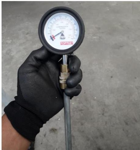
6. Con el compresímetro correctamente acoplado en el alojamiento de la bujía, y verificando que el compresímetro este con sus valores en cero, damos arranque al motor de manera prolongada y continua hasta por unos 12 a 15 segundos, hasta que la aguja indicadora deje de moverse y apunte a un solo número en el compresímetro. Se realizó el mismo procedimiento en todos los cilindros del motor, rotulando cada valor según corresponda a cada cilindro, 1, 2, 3, 4, etc.
