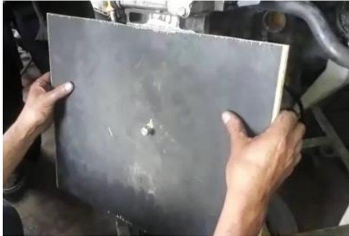
4. Una vez señalado el punto centro, procedimos a señalar los puntos donde se colocaran los pernos de sujeción, teniendo en cuenta el punto más alejado del centro. Se colocó un punzón del diámetro adecuado acorde al tamaño del agujero donde van ubicados los pernos de sujeción de la caja de cambios en el motor (1/2).
