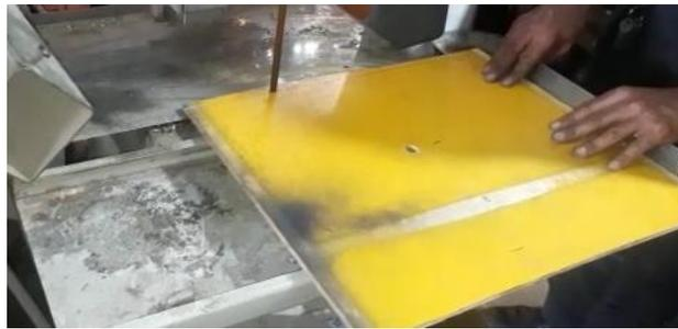
9. Manteniendo el punzón en el punto centro, medimos la circunferencia donde encajará el volante de inercia, desde el punto centro obtenido en el molde de madera, trazamos una circunferencia con el radio medido y procedemos a cortar, dejando culminado el molde de madera.
