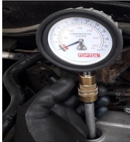
7. Interpretamos los resultados obtenidos en la prueba: Analizamos los valores obtenidos durante la prueba, cilindro por cilindro, para ello, se tuvo en cuenta que: las lecturas de presión en un motor a gasolina standard deben ir entre los 100 y 150 PSI. Hemos analizado los resultados que oscilan entre los 120 a 130 PSI, lo cual nos indicó que el motor no presenta problemas graves o problemas en los cilindros, rines, o demás componentes internos importantes del motor.
