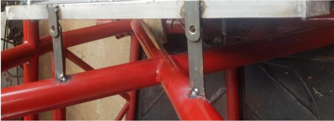
Para evitar las vibraciones y sonidos al momento de la conducción, se elaboraron bujes de grilon, mismos que son montados en las bases del radiador y sujetos en los agujeros de sujeción de las bases.
