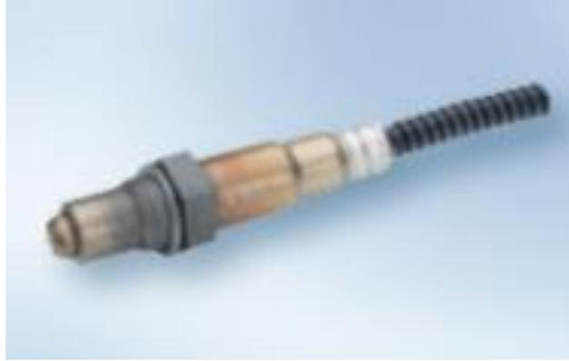
Nota: Sonda Lambda de sistema de inyección electrónica. Tomado de: (Bosch, 2016)
