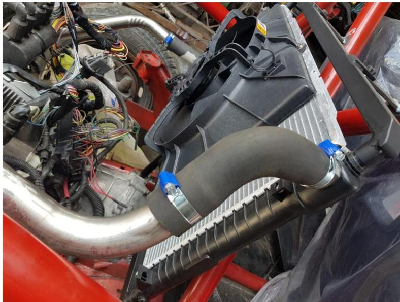
10. Se instaló el depósito de refrigerante, conectamos sus cañerías correspondientes de entrada al radiador y retorno, asegurándolo bien para no tener problemas en su sujeción.
