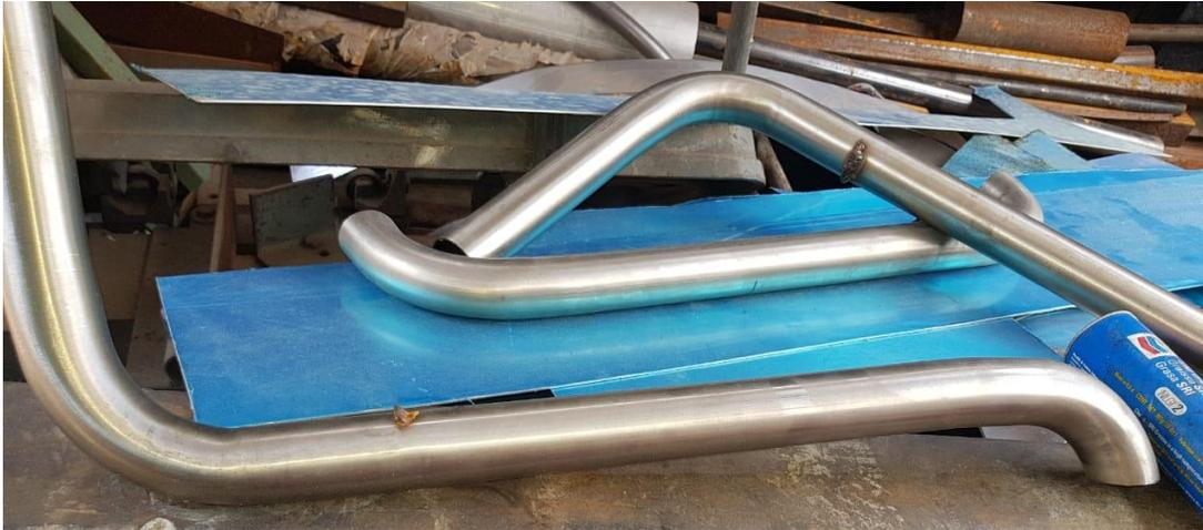
8. Se procedió a realizar los dobleces del tubo con una herramienta especial para este trabajo, misma que permite ajustar el ángulo para realizar la curvatura a conveniencia, según sea necesario.
