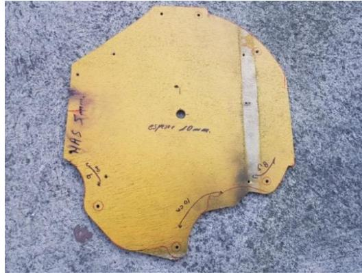
10. Una vez listo el molde, lo siguiente es, pasar a realizar el trabajo en el material metálico, la plancha de metal será el acople definitivo, mismo que será la unión entre la caja de cambios y el motor. Fundamentándonos en el uso que recibirá dicho acople, se ha procedido a elaborarlo con material metálico de hierro dulce, de 10mm de espesor, mismo que será suficiente para soportar los sometimientos de trabajo en su uso.
