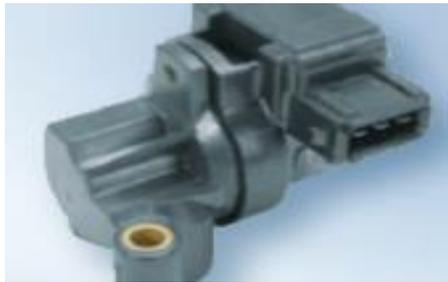
Nota: Válvula IAC de sistema de inyección electrónica. Tomado de: (Bosch, 2016)
