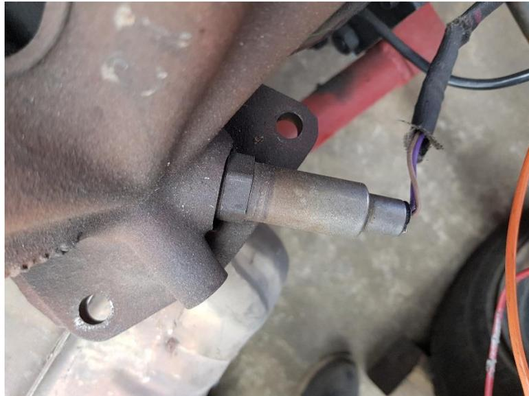
4. Manteniendo el esquema eléctrico específico del sistema del vehículo como guía, procedimos a ubicar cada uno de los zóques e identificarlos según corresponda para cada sensor. Se conectó cada uno de los zóques del arnés con los sensores, nos aseguramos que estén bien conectados y se los señaló a cada sensor y su zóque correspondiente, para poder
