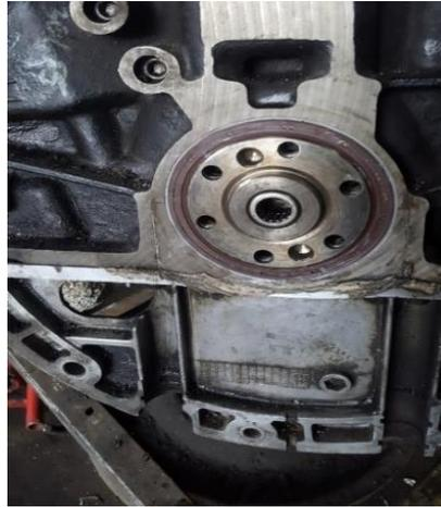
4. Limpiamos el alojamiento del retenedor, lo dejamos libre de impurezas y con cuidado de no cubrir los orificios de los pernos, se colocó silicona gris automotriz, colocamos el nuevo retenedor en su respectivo alojamiento, siempre haciéndolo con técnica para que encaje de manera progresiva, lo más recto y centrado posible, ayudándonos con un martillo de goma para empujar suavemente al retenedor.
