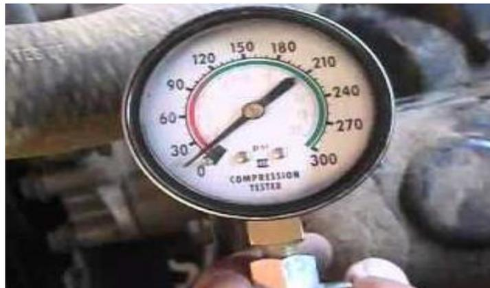
1. Procedimos a realizar la prueba con el motor a temperatura de funcionamiento estándar, es decir, que el motor esté a temperatura de trabajo, realizarlo con el motor caliente hará que sean más precisos los datos obtenidos.
