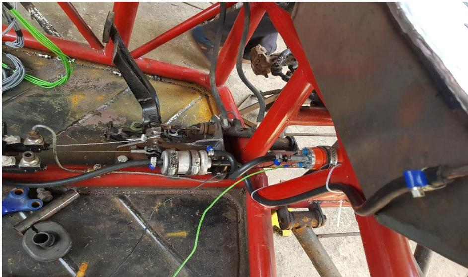
7. La bomba de combustible utilizada es eléctrica, la instalación eléctrica de la misma se la ha realizado creando un puente de conexión saliente desde el switch en posición de contacto, es decir, la bomba de combustible se pondrá en funcionamiento, sólo cuando la
