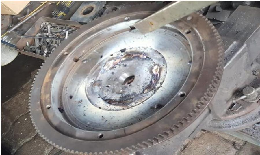
3. Cuando se terminó el proceso de soldadura, con la ayuda de una pulidora, retiramos el exceso de material y la escoria presente del procedimiento de fundición o unión de materiales por soldadura Smaw.
