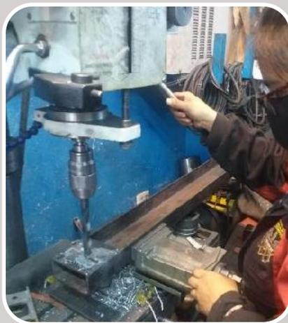
Construcción de los brazos de la pala, y puntos de sujeción
