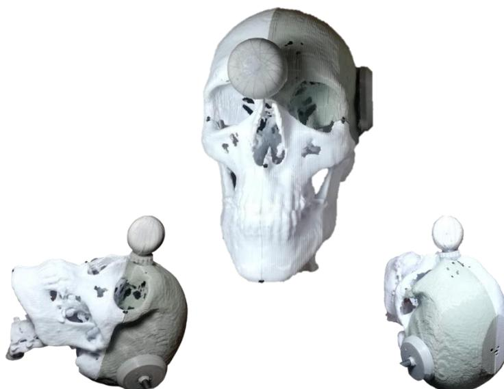
*Nota:* De color gris se observa uno de los cuatro componentes del ensamble del cráneo (pieza n°1, Anexo D-2). Sobre el espacio comprendido entre las cejas, conocido como Glabella, se posiciona la esfera reflectiva de la cabeza; misma que es utilizada para la estimación de pose.
