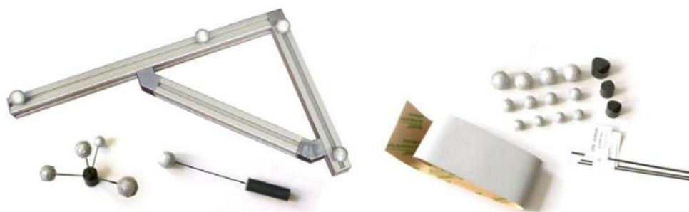
*Nota:* Se muestra distintos arreglos de marcas pasivas (esferas reflectivas). El material reflectivo de infrarrojo se recubre en esferas generalmente plásticas y son colocadas en arreglos o según sea conveniente. Tomado de L-shaped room calibration target (Pintaric & Kaufmann, s. f.) Affordable Infrared-Optical Pose-Tracking for Virtual and Augmented Reality
