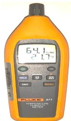
*Nota.* La figura indica el equipo patrón medidor de temperatura y humedad Fluke 971.
