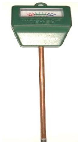
*Nota.* La figura presenta el equipo patrón medidor de humedad de suelo Dr. Meter.
