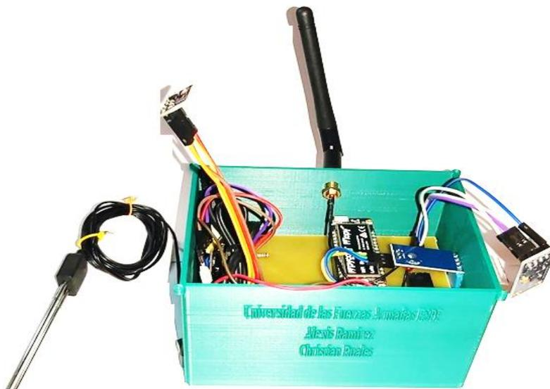
*Nota.* La gráfica muestra la conexión de los sensores y placa de desarrollo dentro de la carcasa.
