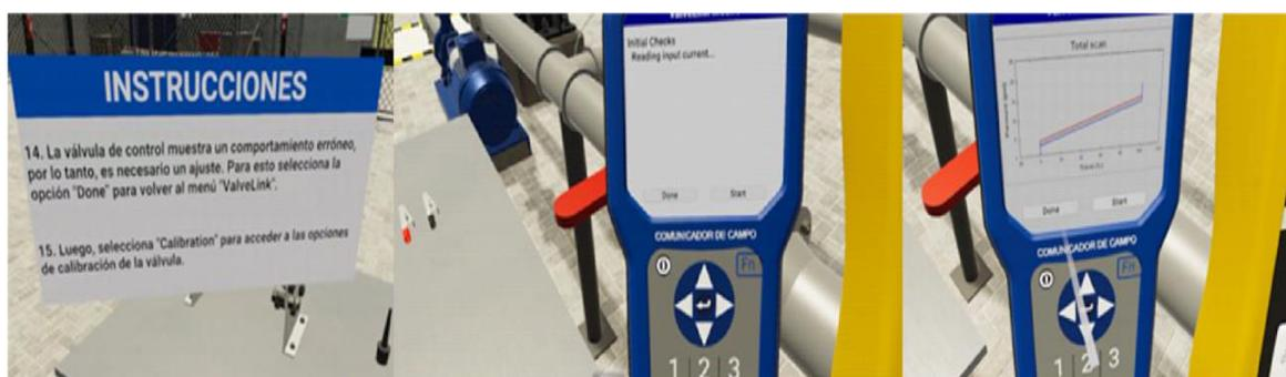
Del procedimiento de calibración de la válvula de control se puede observar que en la figura 4.16 se presenta la firma de la válvula descalibrada, el sistema permite realizar el procedimiento de ajuste de la válvula de control con el fin de disminuir el error y ubicarlo dentro del rango considerado como aceptable, en la figura 4.17, se presenta la firma de la válvula calibrada.
