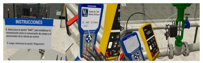
Procedimiento de ajuste de la válvula de control y la obtención de la firma de la válvula (resultado "válvula calibrada")
