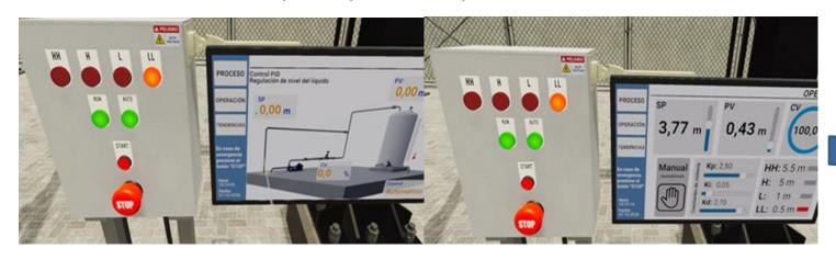
Controlador sintonizado y en funcionamiento con un mínimo error
