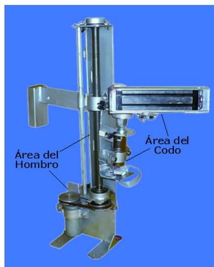
**Figura. 6.02. Fotografía del brazo manipulador vista frontal.**
