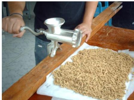
**Figura 10. Pelletización del balanceado**
