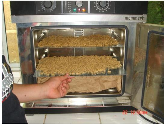
**Figura 11. Secado del balanceado en la estufa**
