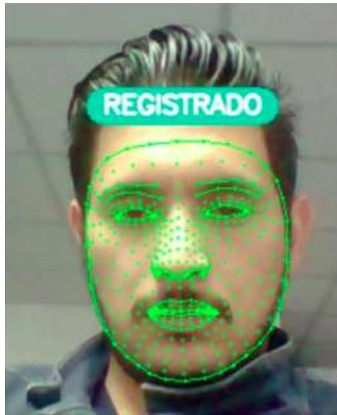
*Nota:* La figura muestra la predicción del usuario identificado en el sistema de reconocimiento facial y los 468 rasgos faciales del modelo de MediaPipe.
