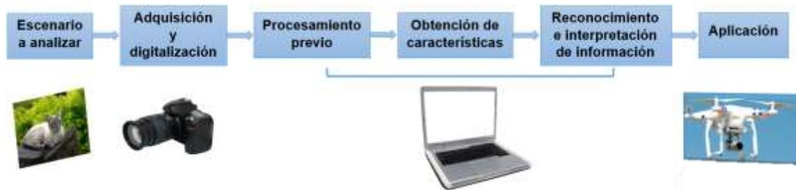
Nota: La imagen muestra cómo está compuesta las etapas de un sistema de visión por computadora. Tomado de *Etapas de un sistema de visión - Visión artificial*, (Solución Ingenieril, 2021)
