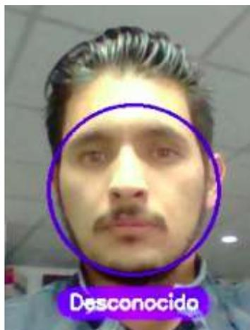
*Nota:* En la figura se muestra la detección en tiempo real del rostro con el modelo de RetinaFace
