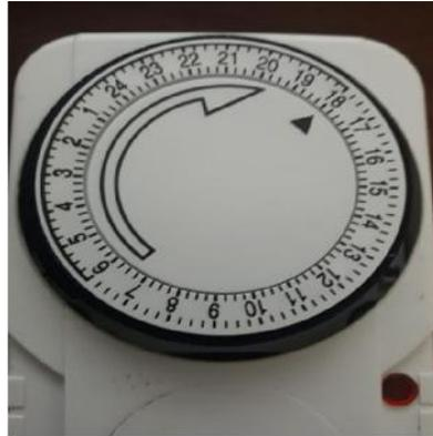
**Paso 3:** Bajar las perillas de las horas en que el temporizador debe encender la iluminación para la implementación del sistema, se baja las perillas 18H00 a 06H00, figura 38.
