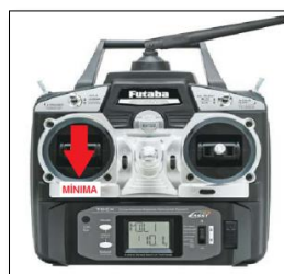
Figura 3.40: Posición Mínima del Mando del Acelerador Fuente: Investigación de Campo
