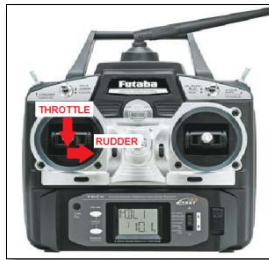
Figura 3.41: Posición de Mandos de Control para Armado de Motores Fuente: Investigación de Campo
