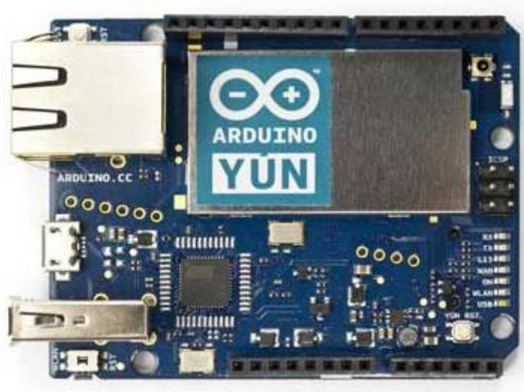
**Figura 5: Tarjeta Arduino Yún.**
