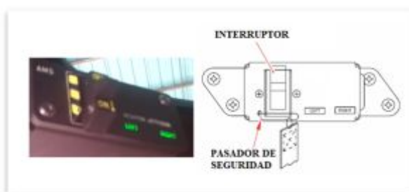
Figura 14: Interruptor maestro de armamento (AMS).
