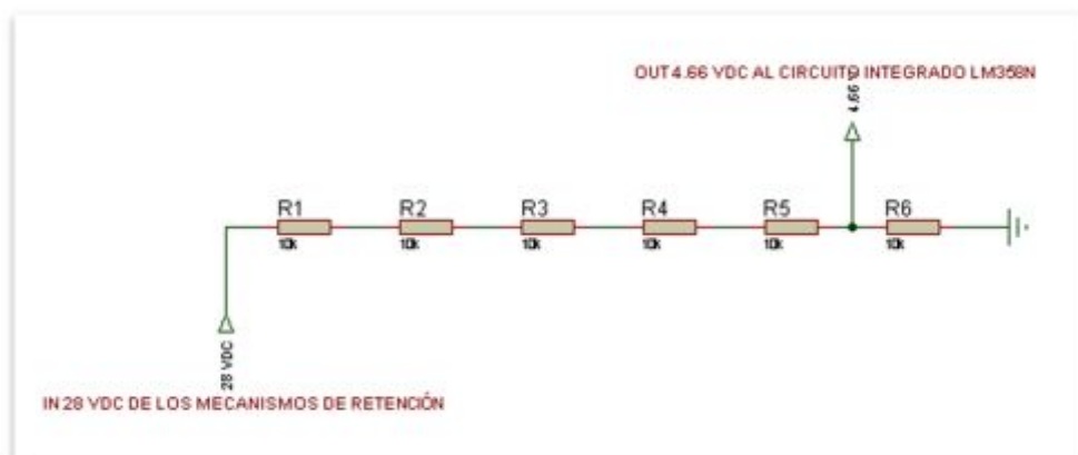
Figura 54: Circuito divisor de voltaje (Opción 2).
