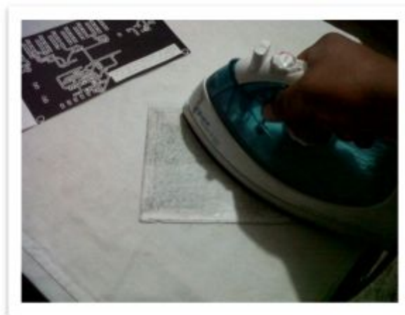
Figura 81: Planchado de placa.
