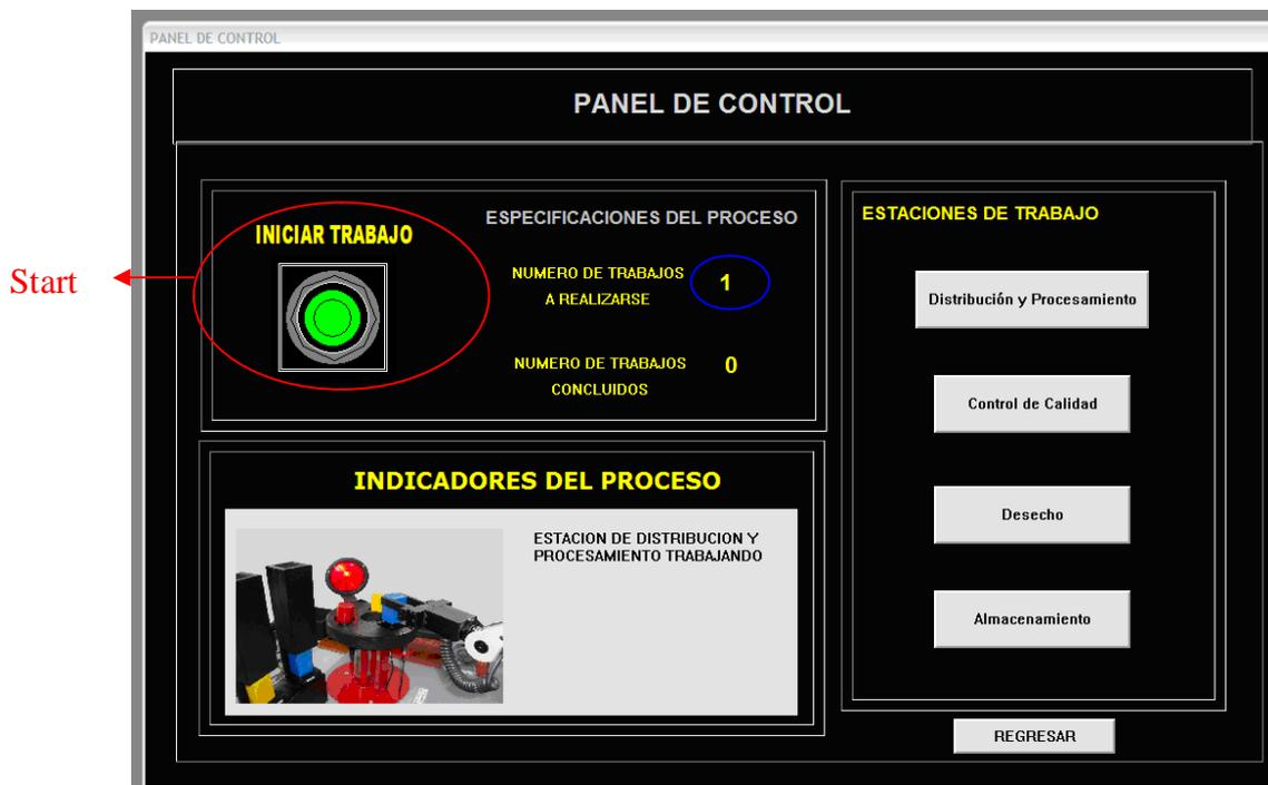
Como se puede observar en la pantalla usted puede visualizar la estación en la que se encuentra la pieza que esta procesándose, y puede dar clic en los links dedicados para la visualización del estado de cada estación. En el ejemplo se ilustra el inicio del trabajo, pues la pantalla de indicadores del proceso muestra que la estación de distribución y procesamiento de piezas esta activada.
