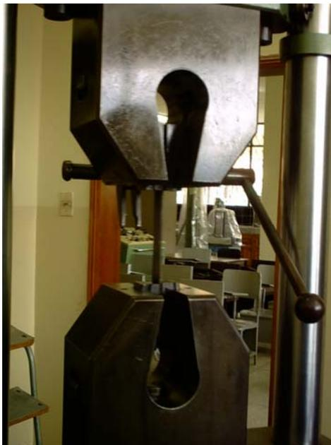
Con las probetas construidas se procedió a realizar el ensayo colocándolas en las mordazas de la máquina de ensayos universales AMSLER RM29.
