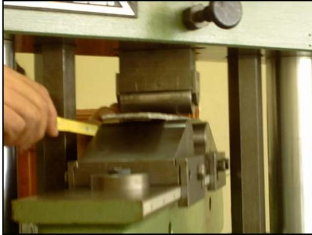
**Figura 6.12** Aplicación de carga a la probeta
