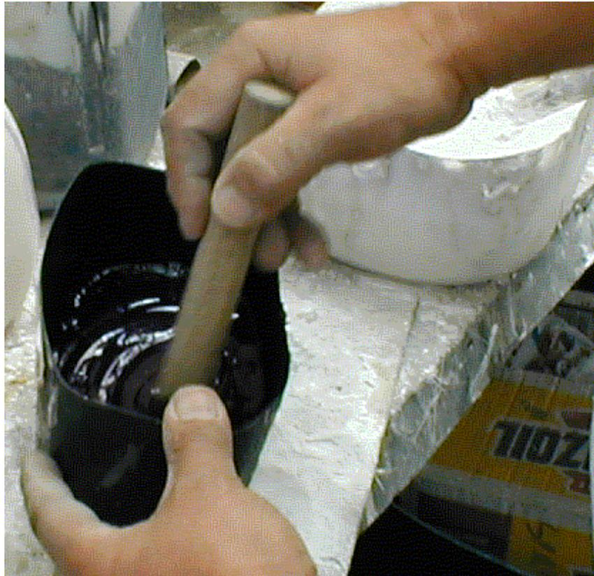
La tercera fase del proceso por moldeo a mano, es el laminado o estratificado de la capas de fibra y resina sobre el molde. Se comienza por verter sobre el molde tres capas de yelco, con una brocha limpia, cada una con intervalos de 30 minutos. Se debe esperar un tiempo de 2 horas antes de proceder a la laminación, es decir, a partir de la última capa de yelco colocada sobre el molde.
