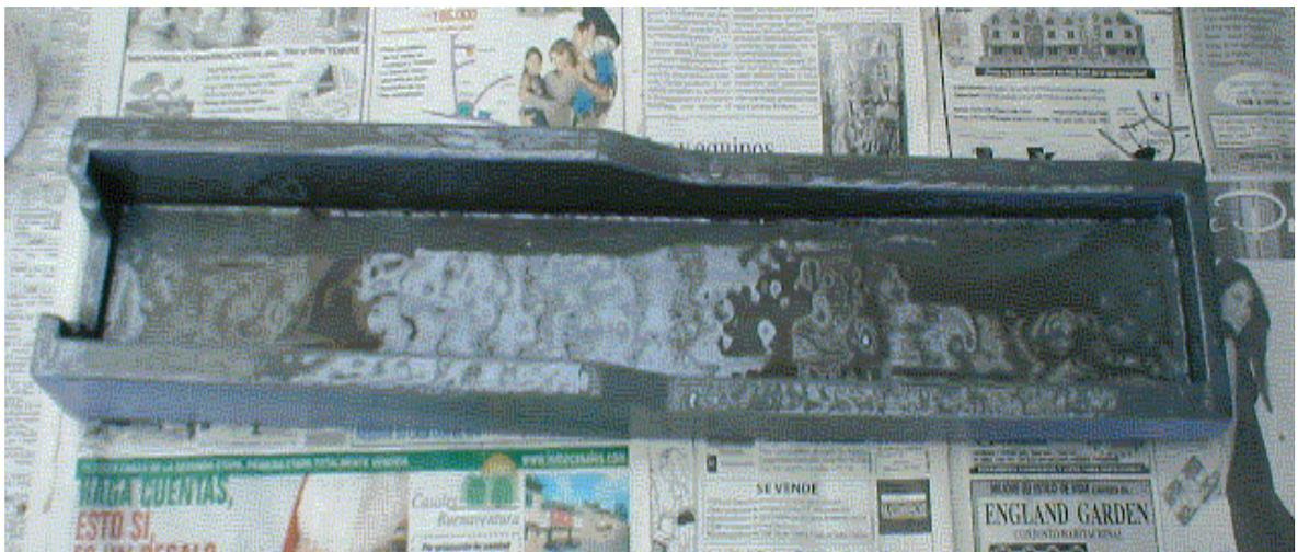
Una vez que se haya secado la última capa de yelco, se coloca la capa conformada de fibra de carbono en el molde y se procede a mojarla con resina epoxi combinada con el endurecedor 2020.
