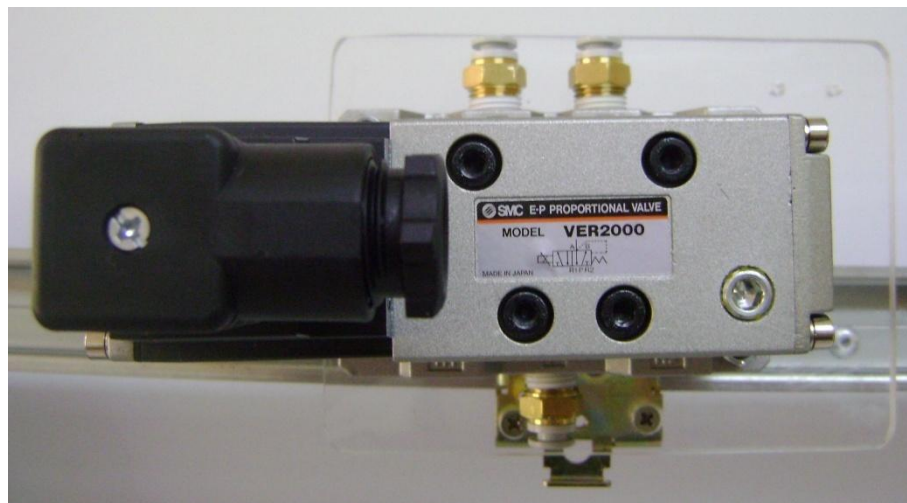
Figura. 3.14. Válvula electroneumática proporcional 5/2 de doble bobina
