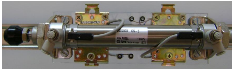
Figura. 3.8. Cilindro de doble efecto con sensores reed
