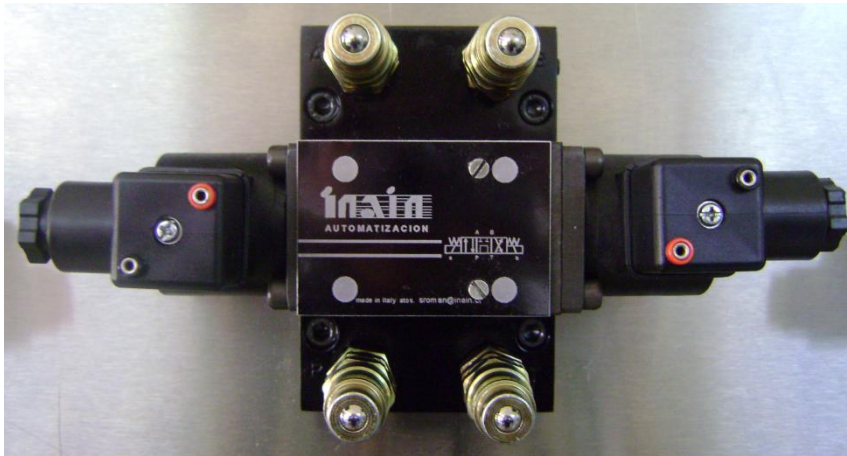
Figura. 3.37. Válvula distribuidora 4/3 vías biestable posición central Tándem
