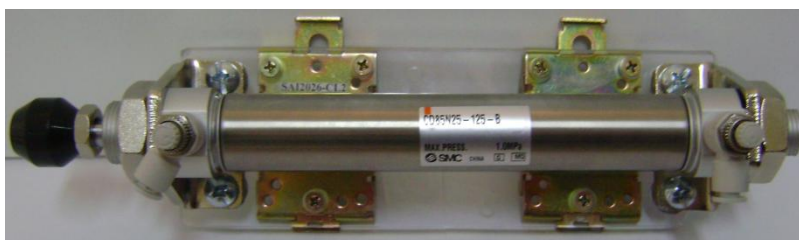
Figura. 3.7. Cilindro de doble efecto sin sensores reed
