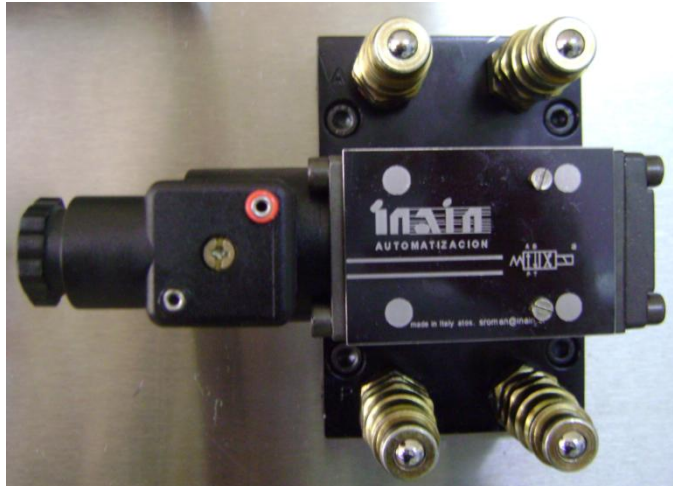
Figura. 3.35. Válvula distribuidora 4/2 vías monoestable
