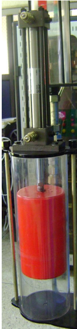
Figura. 3.33. Cilindro de doble efecto con sistema de peso
