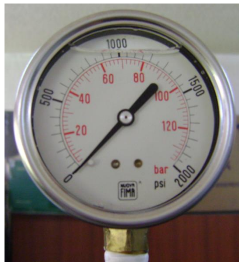
Figura. 3.49. Manómetro con glicerina
