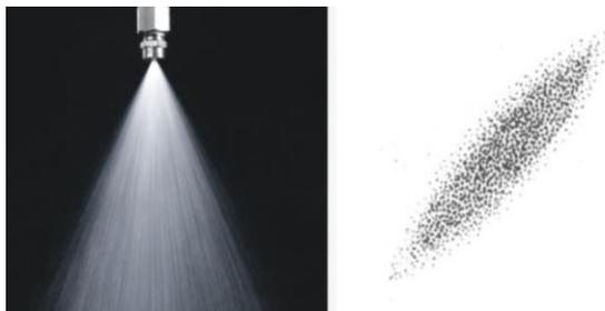
*Nota:* Imagen de la izquierda muestra la aspersión plana por orificio elíptico. Imagen derecha marca de agua en superficie plana perpendicular al chorro de aspersión. Tomado de la página del distribuidor *InduServices*, s.f. [https://induservicesecuador.com/tipos\\_de\\_aspersion.html](https://induservicesecuador.com/tipos_de_aspersion.html).
