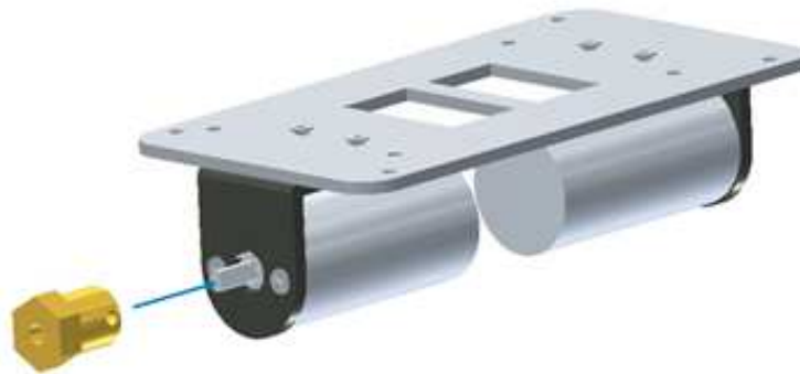
Figura 83 Instalación del acople
