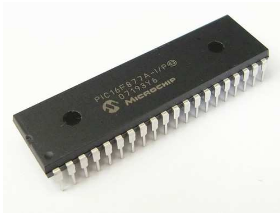
Figura 3 PIC 16f877A fabricado por Microchip
