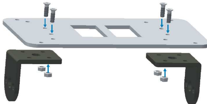
Figura 81 Instalación de los soportes de los motores
