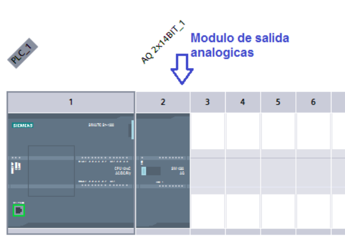
Figura 47. Modulo SM 1232 AQ conectado al PLC.
