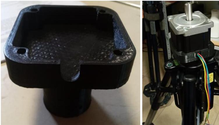
La Figura 32 presenta el diseño del acoplamiento de la base de antenas al motor.
