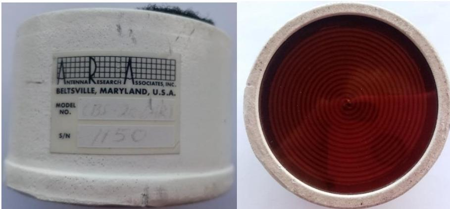
Una fotografía de la antena espiral modelo CBS-218-40 se presenta en la Figura 28, esta antena tiene un V.S.W.R.  $\leq 2:1$ , potencia máxima de 4 W, polarización circular: RHCP (del inglés, Right Hand Circular Polarized) o LHCP (del inglés, Left Hand Circular Polarized) y utiliza un conector SMA hembra. (Antenna Research, pág. 76)
