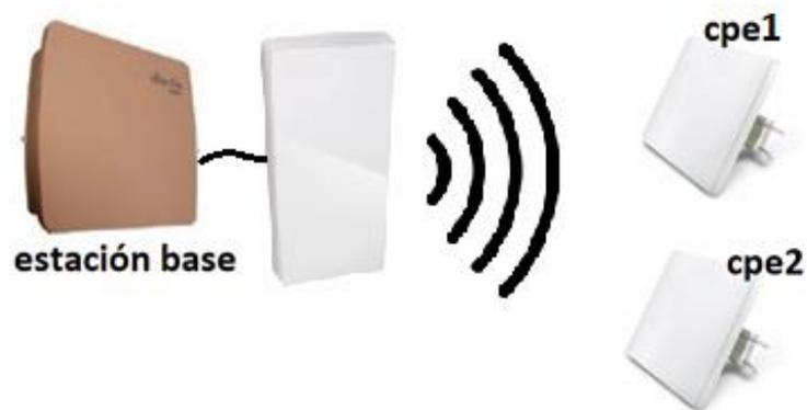
Por otro lado, para cumplir con los objetivos establecidos en el segundo enlace se implementó la RS. En la Figura 33 se observa la segunda conexión que se realizó con la RS, la cual tiene 3 saltos, el primer salto va desde la PC1 o transmisor hasta la RS, el segundo salto va desde la RS hasta la BS, y finalmente el último salto va desde la BS hasta la PC2 o el receptor.
