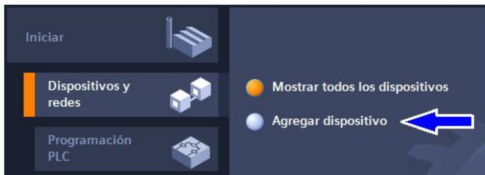
Figura 38 Agregar dispositivo en el software TIA Portal V13
