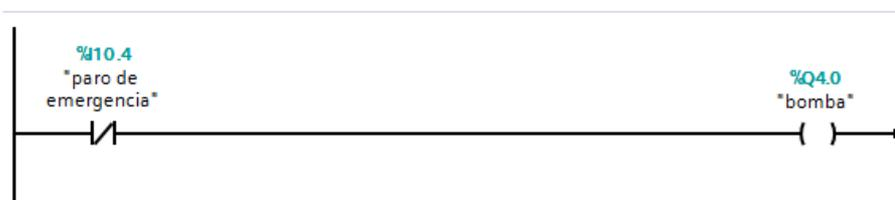
Figura 79 Segmento activación bomba
