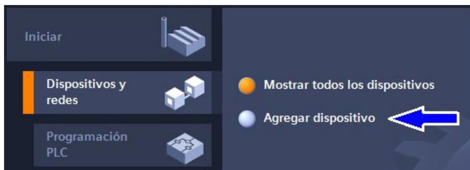
Figura 13 Agregar dispositivo en el software TIA Portal V13
