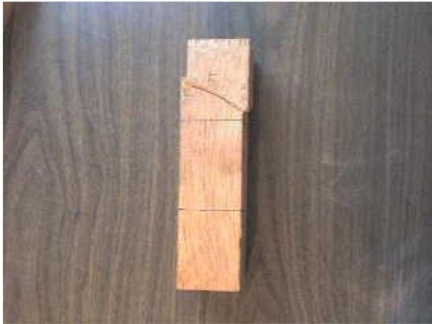
**Figura 5.8** Probeta de un ensayo bien realizado
