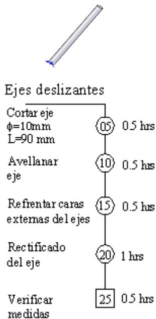
**Figura 4.8** Diagrama de operación para ejes deslizantes
