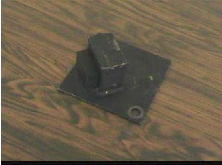
**Figura 3.19** Probeta de caucho empotrada en estructura de acero
