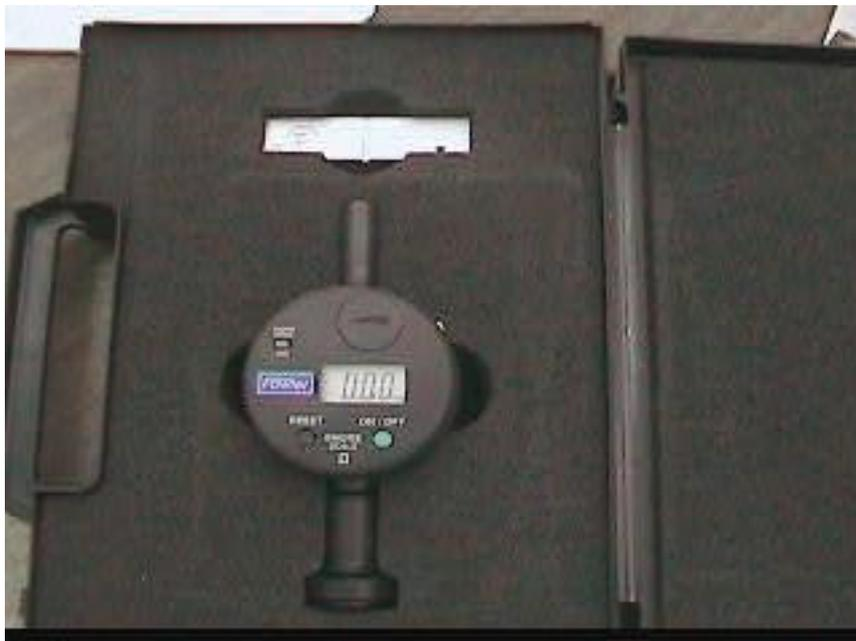
**Figura 3.5** Durómetro en escala SHORE
