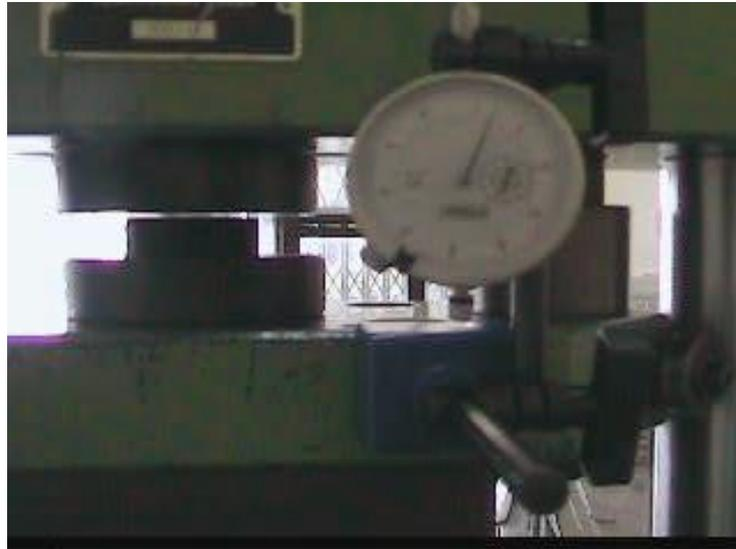
**Figura 3.7** Ensayo de compresión para caucho
