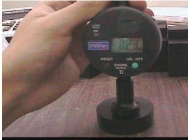
**Figura 3.6** Ensayo de dureza para caucho
