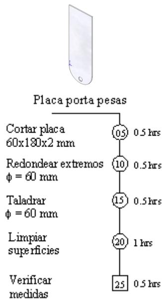
**Figura 4.2** Diagrama de operación para placa porta pesas
