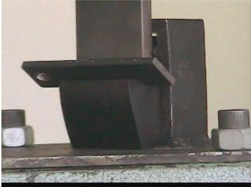
**Figura 3.17** Ensayo de corte directo en caucho.
