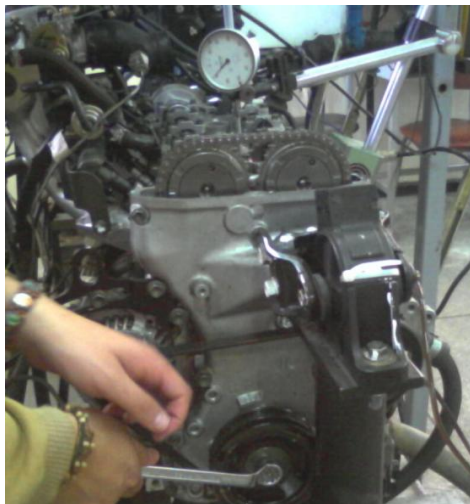
Figura 3.16: (Verificación del punto muerto superior con las marcas en la polea del cigüeñal)
