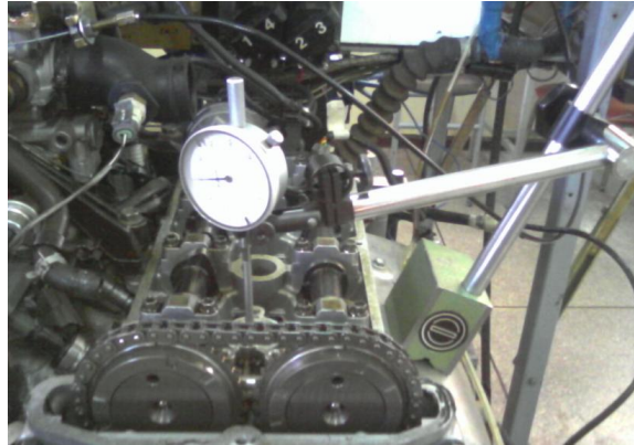
Figura 3.15: (Instalación del palpador en el primer cilindro)
