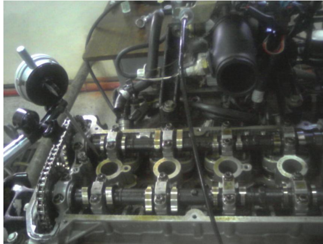
Figura 3.26: (Toma de datos de los ángulos de apertura y cierre en admisión)
